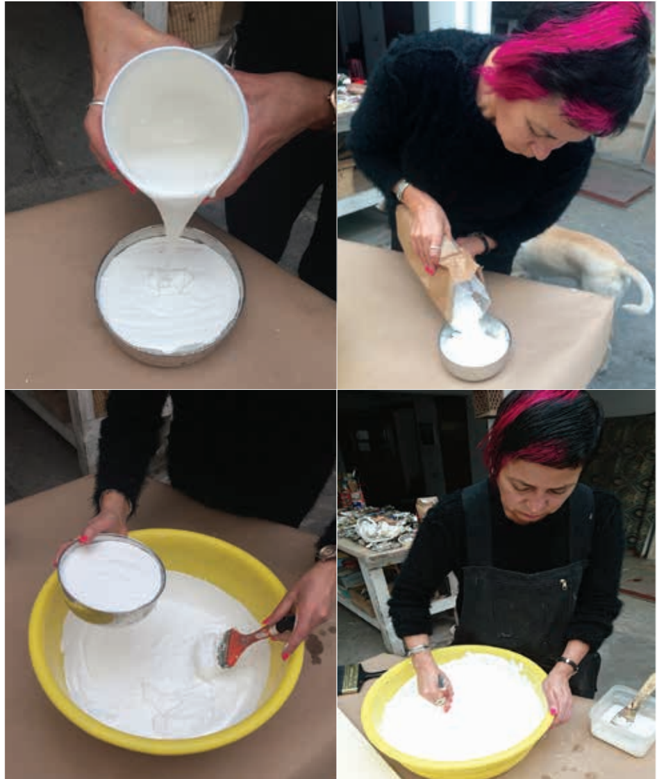
Figura 2. Incorporación de los volúmenes de blanco de titanio, carbonato de calcio, sellador y agua, respectivamente.
