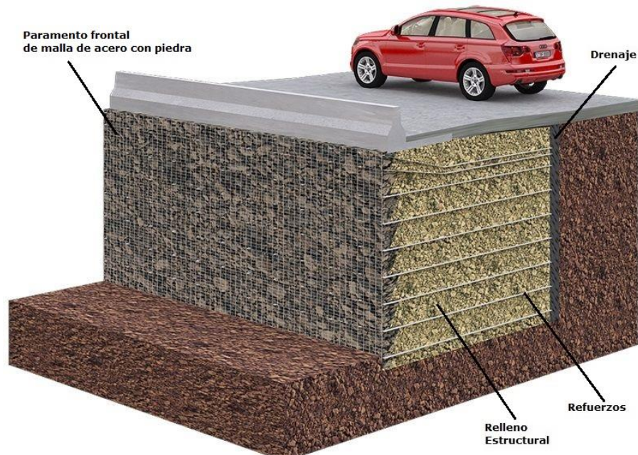
Ilustración 2. Diagrama de muro mecánicamente estabilizado.
