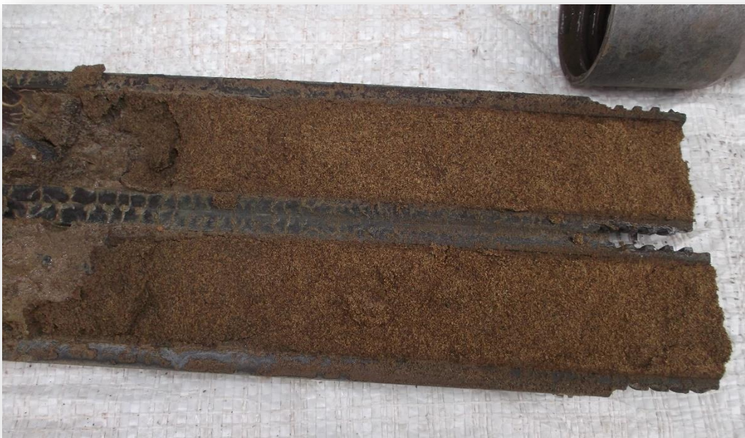
Ilustración 14. Muestra obtenida mediante penetrómetro.
