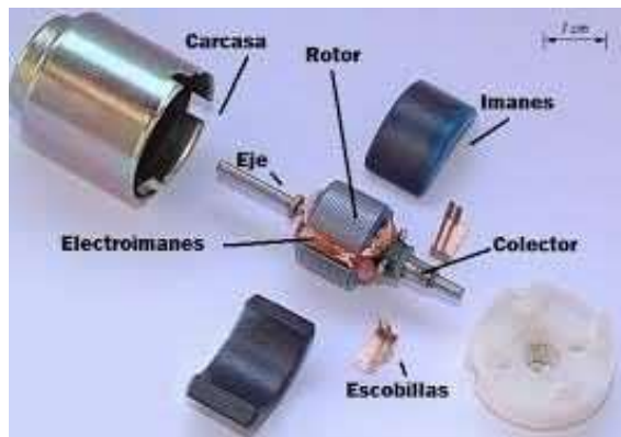
Fig. 5. Partes de un motor de corriente continua. Fuente: https://i1.wp.com/www.ingmecafenix.com/wp-content/uploads/2017/04/motor-partes.jpg?ssl=1
