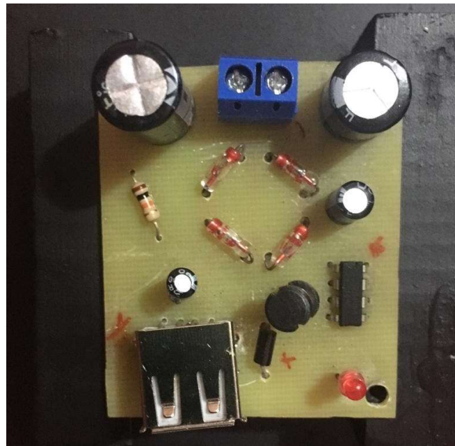
Fig. 96. Circuito rectificador y convertidor Buck en placa fenólica. Fuente propia.
