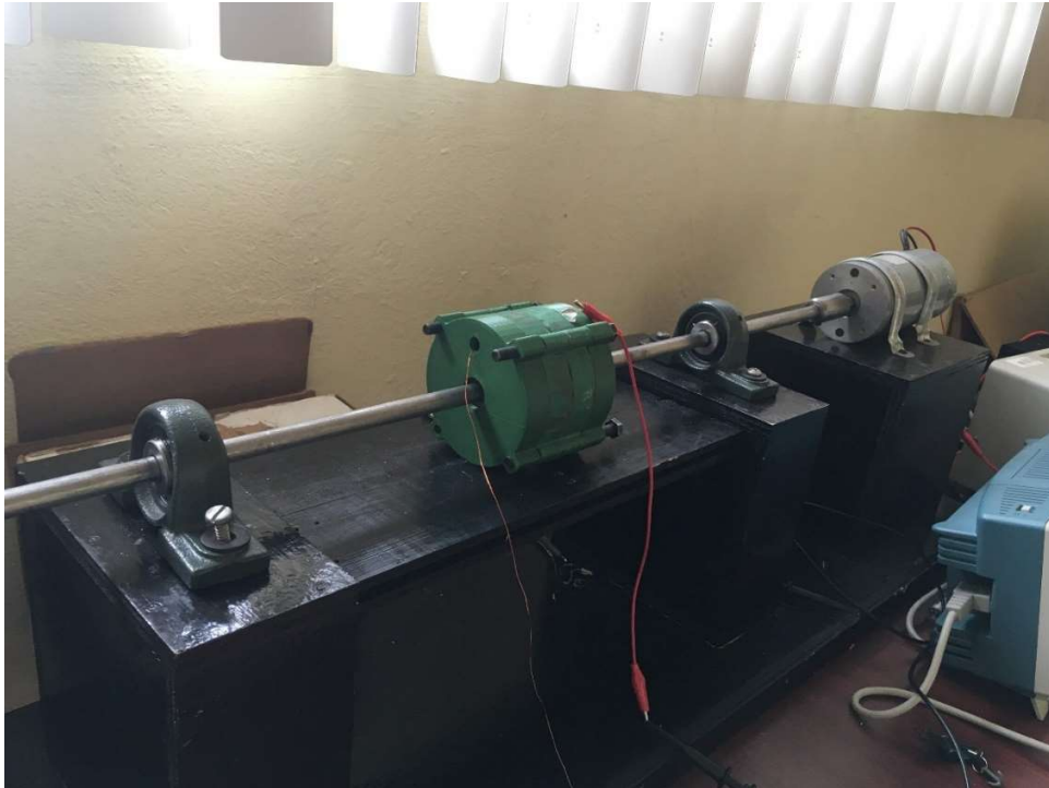
Fig. 90. Implementación del acoplamiento mecánico. Fuente propia.
