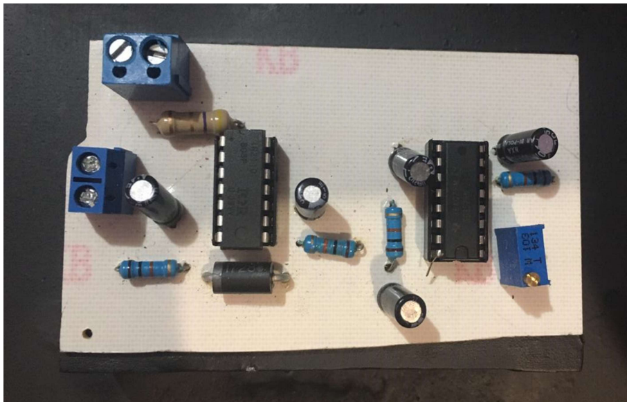
Fig. 92. Circuito de control de velocidad implementado con tecnología THT. Fuente propia.
