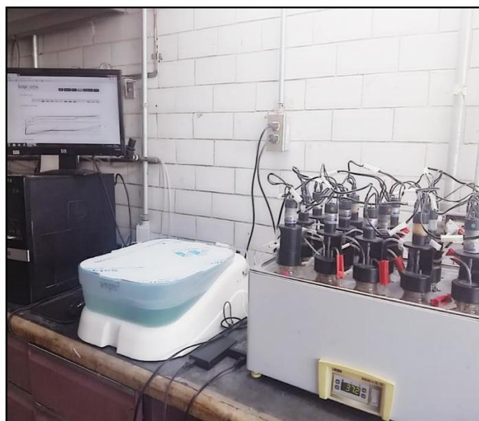
Figura 22. Equipo: Automatic Methane Potential Test System (AMPTS)
