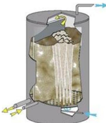
Figura 13. Esquema del biodigestor Valorga, las flechas amarillas indican la entrada y salida de los residuos, las flechas azules la salida y recirculación de biogás (Valorga International SAS., 2007).
