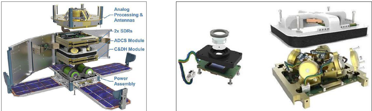
Figura 1.14. Diseño modular del satélite Prometheus (izq.), sensor de sol y pirámide redundante de ruedas inerciales (der.) (Crédito: Laboratorio Nacional Los Alamos)
