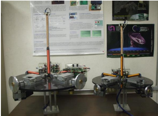
Figura a. Simuladores satelitales con capacidad de 50 y 10 kg, contienen los sensores, actuadores y computadora de abordo (izq.). Balero neumático que simula el medio ambiente casi sin fricción (der.).
