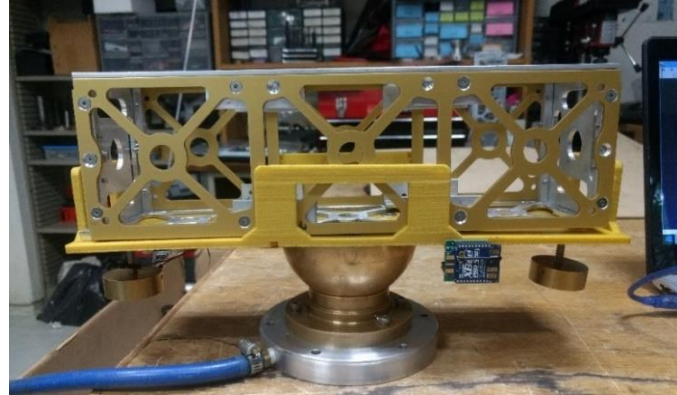
Figura c. Simulador de medio ambiente sin fricción para CubeSat 3U con 360° de libertad en tres ejes (izq.) Plataforma para la determinación del centro de masa en 2 ejes de un nanosatélite (der.).
