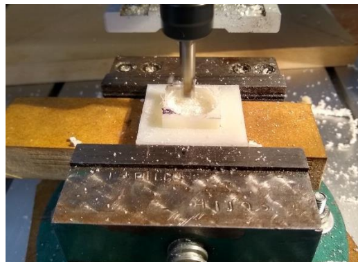
Figura 5.11. Fabricación de piezas que soportan a las bobinas de par magnético. Fabricadas en nilón tipo 6 con velocidad de corte de 500 [mm/min] y profundidad de pasada de 1 [mm]. La herramienta de corte es una fresa de alta velocidad de carburo de tungsteno de 2 hilos de 3/16'.
