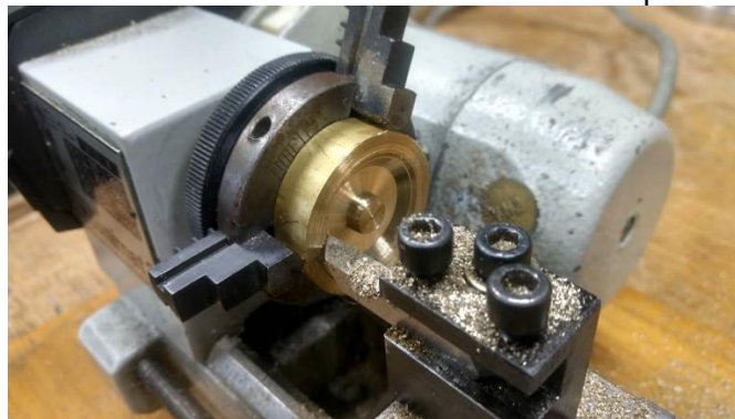
Figura 5.9. Fabricación de la rueda inercial de bronce con un torno; se utilizaron buriles de \frac{1}{4} de acero industrial al cobalto afilados acorde a los ángulos de ataque: cilindrado, refrentado y tronzado [102].
