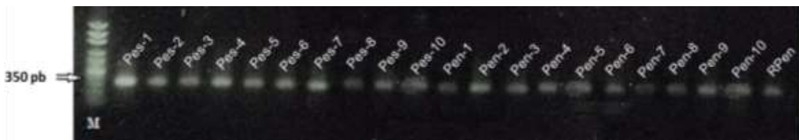
Anexo A2. Gel de electroforesis para verificación de amplicones 16S ARNr en el sistema Palizada-Del Este y el río Palizada. M: marcador de tamaño molecular.
