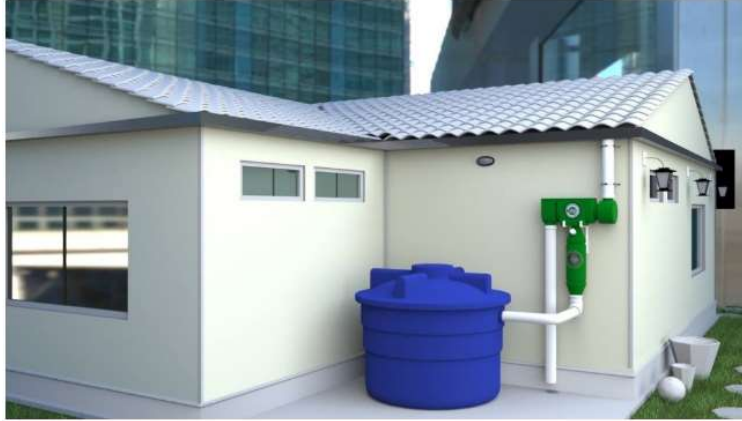
Figura 6 Sistema de captación de agua pluvial
