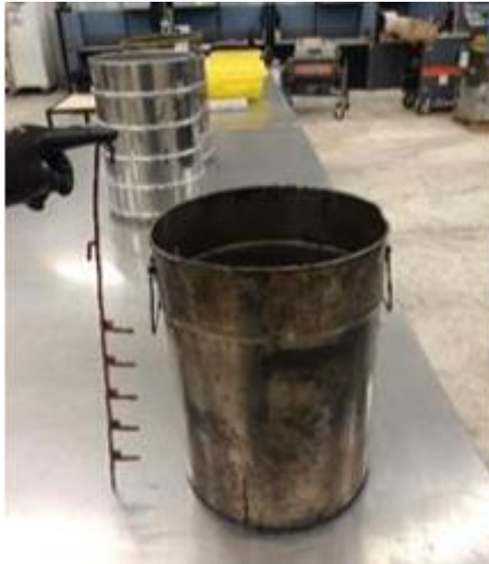
Ilustración 25 Recipiente llamado vasije y varilla estandarizada para medir la expansión del asfalto espumado.
