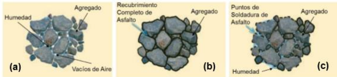
Ilustración 20 Material granular sin estabilizador (a), estabilizada con asfalto (b) y con asfalto espumado (c).
