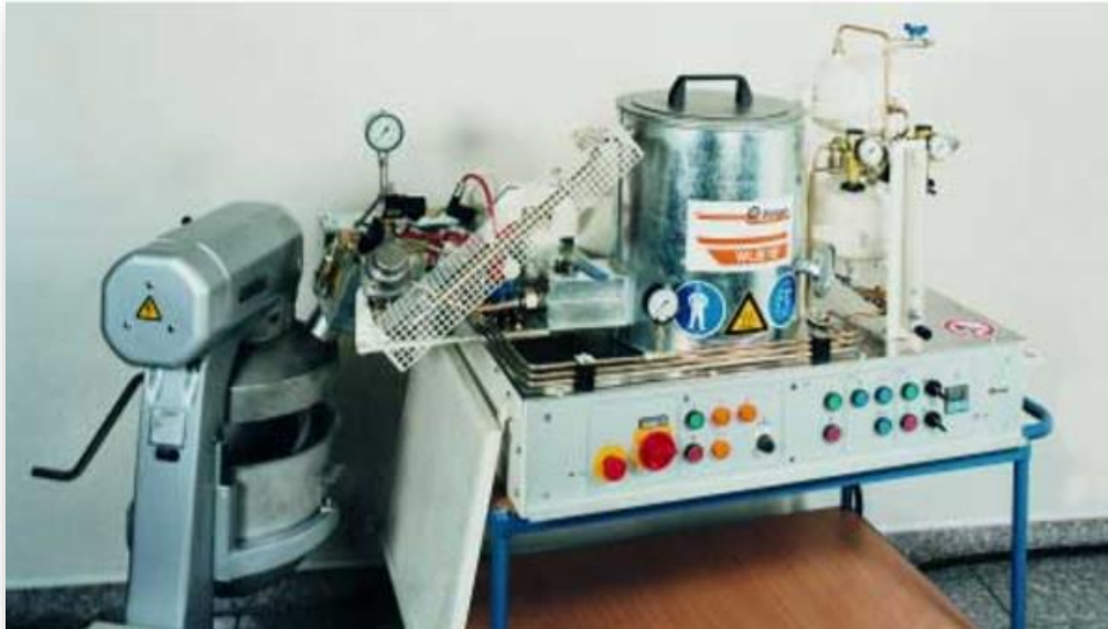
Ilustración 17 Por medio de este equipo de laboratorio, denominado WLB 10, se puede analizar las propiedades del espumado antes del proyecto.
