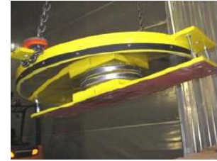
c) Apoyos de péndulo de fricción (FPS)
