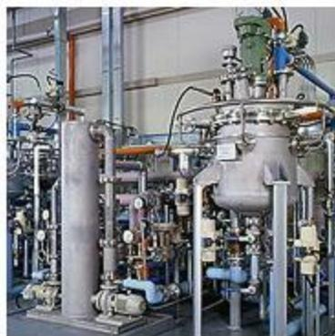
Figura 1.10, Sistema de calentamiento con Vapor al Vacío (TLV, 2019)
