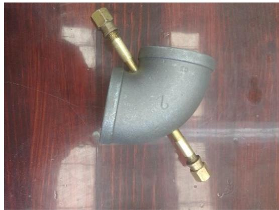
Figura 3.02 codo y nipples. Creación propia.
