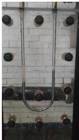
Figura 4.03, Medidor de flujo tipo codo Creación propia.
