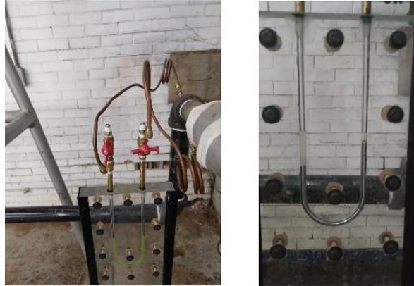
Figura 3.10 y 3.11 Medidor Tipo Codo. Creación propia.
