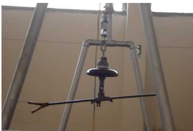
Figura 2.0 Montaje para prueba de tensión de flameo
