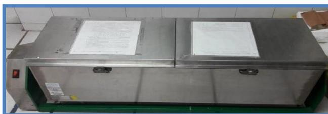
Figura 3.2-1 Agitador mecánico axial.
