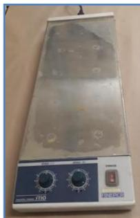
Figura 3.4-3 Equipo de agitación múltiple marca FinePCR.
