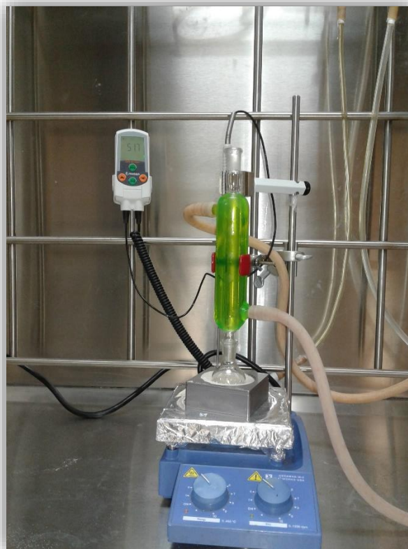
Ilustración 1. Baño de arena con reflujo para calentamiento térmico.
