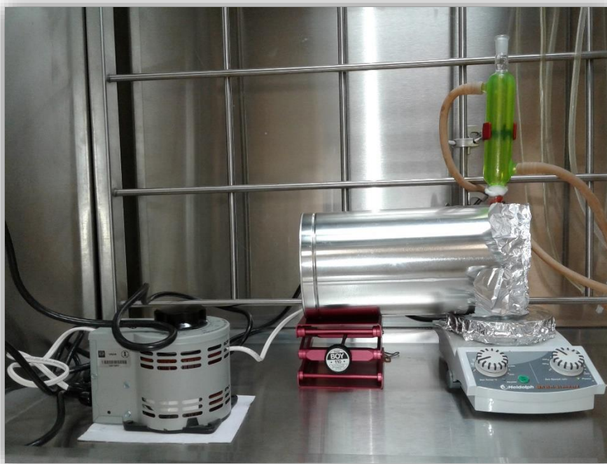
Ilustración 2. Sistema de calentamiento por irradiación infrarroja.
