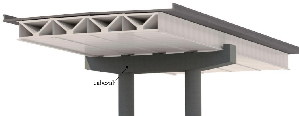
Figura 27. Esquema del cabezal del puente
