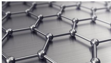
Fig.1 Lámina de grafeno con forma similar al de un panal de abejas. <sup>3</sup>
