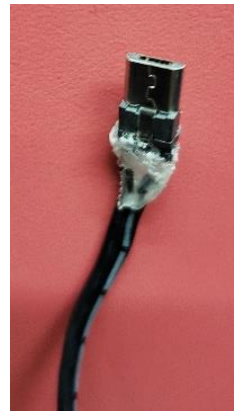
Ilustración 35. Colación de silicón entre conector y cable
