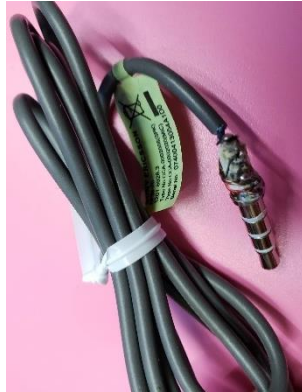
Ilustración 28. Unión por soldadura de cable con conector 3.5
