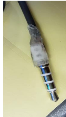
Ilustración 29. Colación de silicón entre conector y cable
