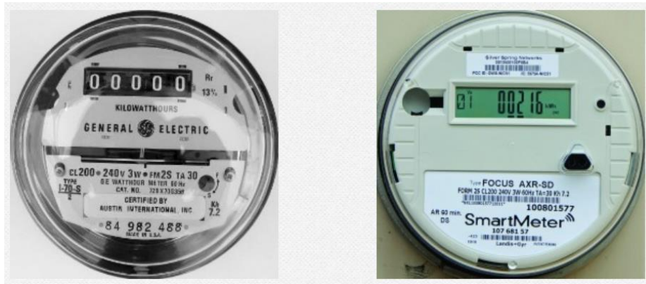
Figura 3-12. Contraste de medidores clásicos contra inteligentes.
