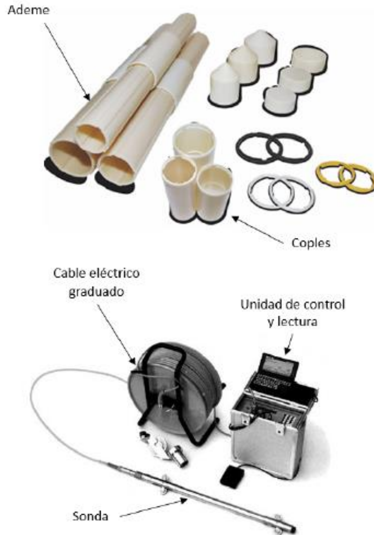
Figura 4.2. Elementos de un inclinómetro. Arvizu, M. (2017)
