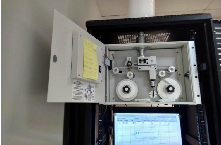
Figura 21. Cambio de cinta al equipo BAM1020.
