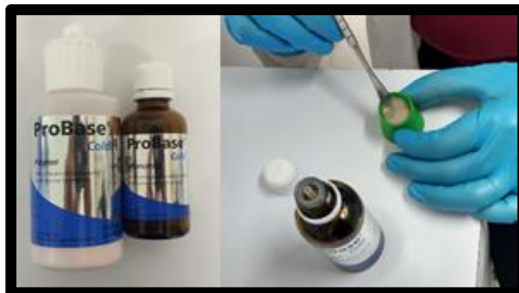
Figura 96 Acrílico ProBase: se realiza el mezclado en un godete y con una espátula de cements. Fuente directa
