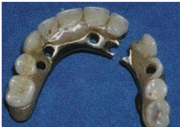
Figura 27 Fractura de la estructura metálica en una prótesis híbrida.
