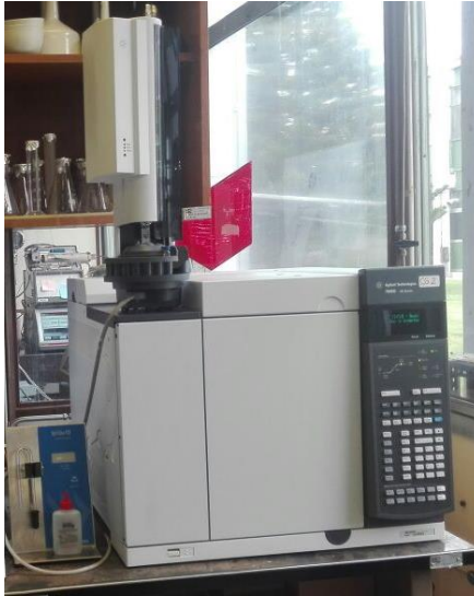
Figura 13. Cromatógrafo de gas FID-GC2, Instituto Mexicano del Petróleo
