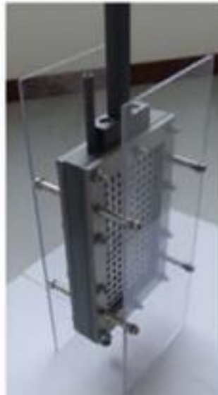
Figura 1. 14. Módulo de tipo hoja plana sumergido directamente en un reactor de mezcla completa (Ersahin et al., 2017).
