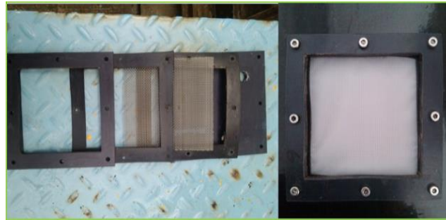
Figura 3. 3. Componentes del módulo de filtración con textil tejido de 50 \mu m.
