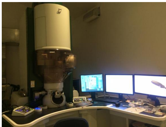
Figura 42. TEM JEOL, JEM-ARM200F modo S/TEM con FEG tipo Schottky.
