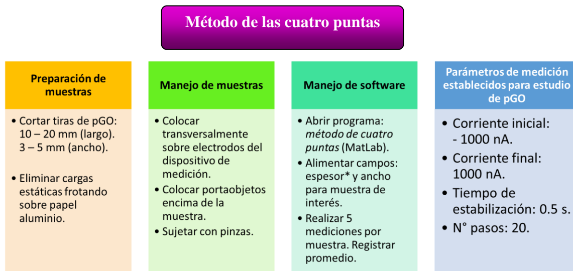
Figura 52. Procedimiento para medición de conductividad en pGO.
