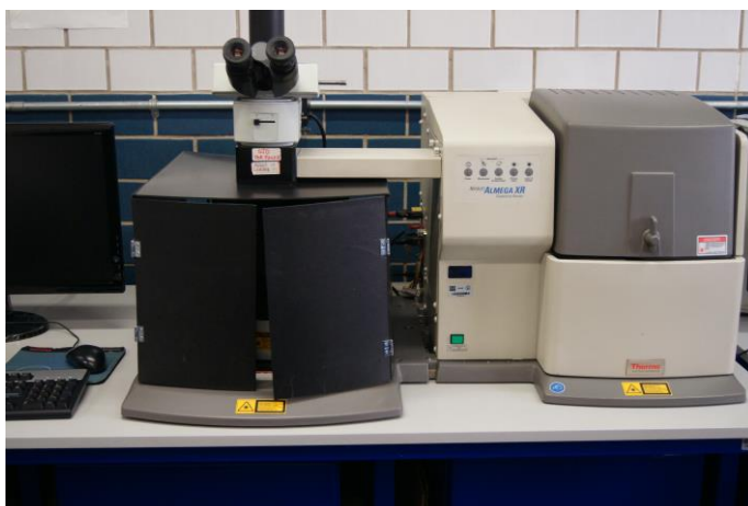
Figura 38. Espectrofotómetro Thermo Scientific, Nicolet Almega XR Dispersive Raman ( \lambda = 532 nm).
