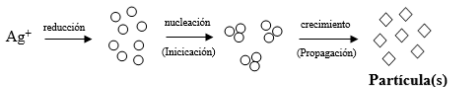
Figura 16. Mecanismo de formación de AgNPs
