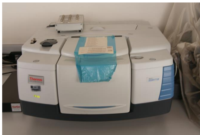
Figura 37. Espectrofotómetro FT-IR Thermo Fischer Scientific, Nicolet iS50R, modo ATR.
