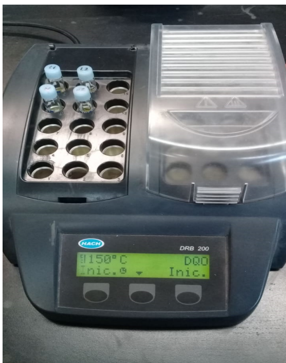
Imagen 75. Colocar viales de digestión en termoreactor Fuente: Elaboración de la autora
