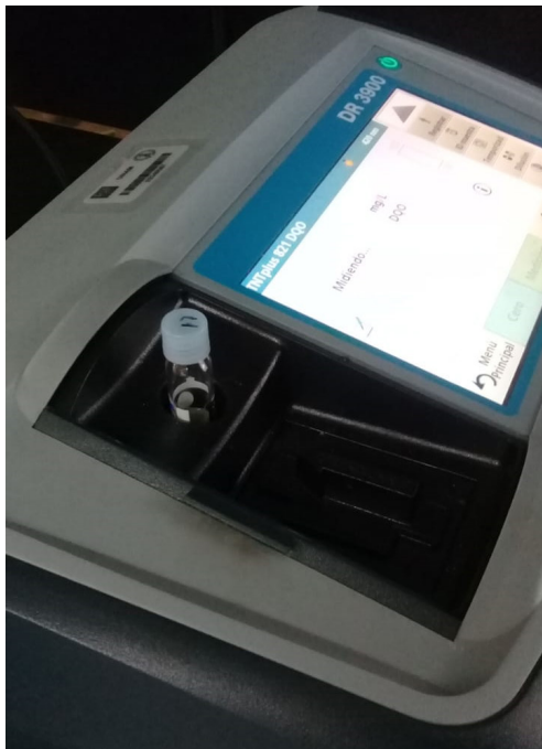
Imagen 77. Colocar viales de digestión en espectrofotómetro Fuente: Elaboración de la autora
