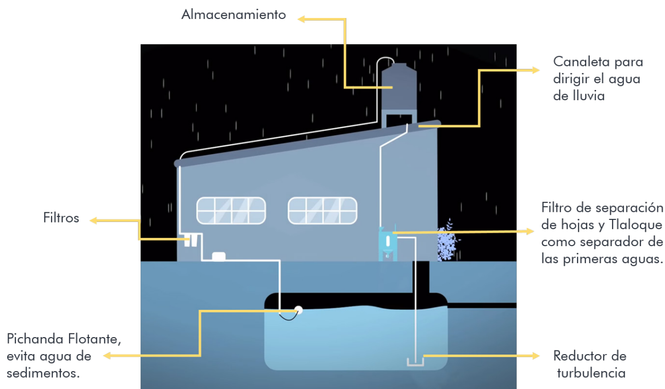
Ilustración 27. Sistema de funcionamiento de Tlaloque Fuente: http://islaurbana.org/sistemas-de-ciudad/
