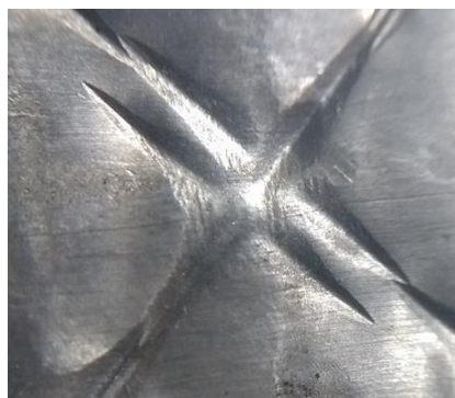
Figura 3. 2. Marcas de la cresta del molde de acero D2.
