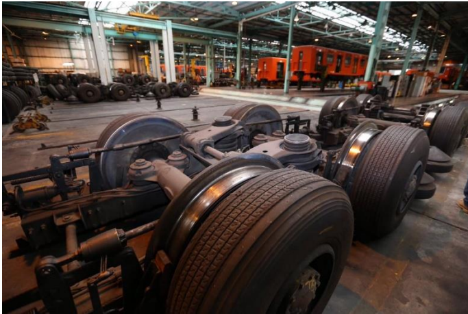
Figura 8: Mantenimiento a diferenciales de 45 trenes de la línea 2. Fuente: Miguel Ángel Mancera. Obtenida de: https://twitter.com/manceramiguelmx/status/78586127111421952 .
