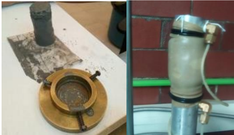
Figura 4.1 Formación y montaje de probeta con un w > 21\% , Instituto de Ingeniería de la UNAM
