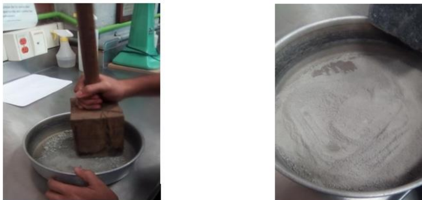
Figura 3.4 Disgregación del material, Instituto de Ingeniería de la UNAM
