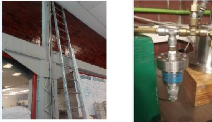
Figura 2.11 Columna de mercurio y sensor de confinamiento, Instituto de Ingeniería de la UNAM
