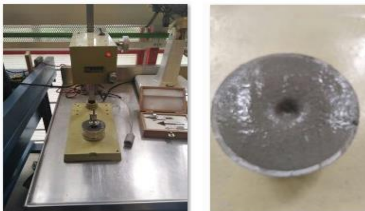
Figura 3.1 Cono sueco, Instituto de Ingeniería de la UNAM
