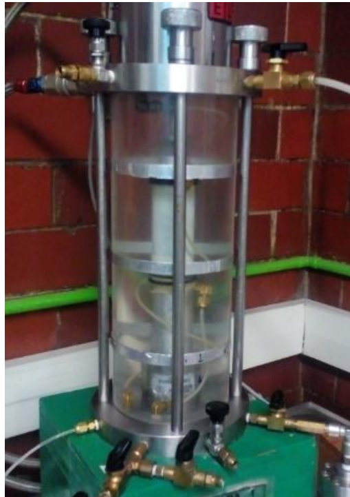
Figura 3.10 Probeta montada en la CTC 1, Instituto de Ingeniería de la UNAM.
