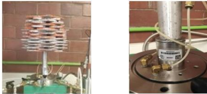
Figura 2.9 Pesas colocadas encima del pedestal y celda de carga, Instituto de Ingeniería de la UNAM
