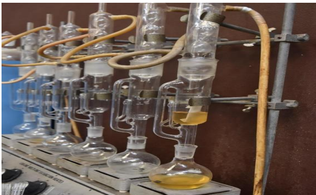
Ilustración 16 Sistema de extracción Soxhlet.
