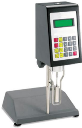
Ilustración 199. Viscosímetro de rotación tipo Brookfield 24
