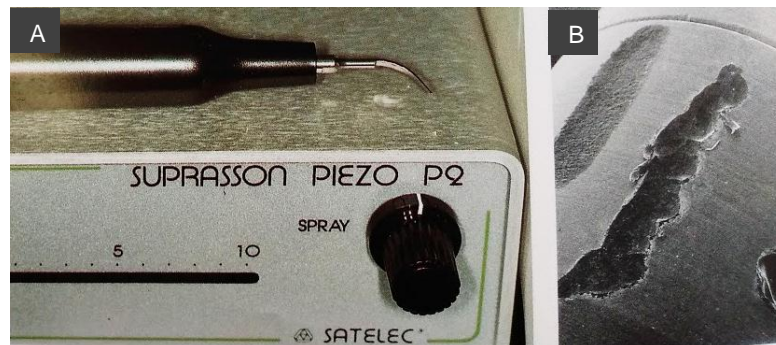
Figura 27. A) Aparato de ultrasonido SATELEC®; B) Microscopía electrónica de barrido de un implante después de ser tratado con punta de acero del ultrasonido. 22
