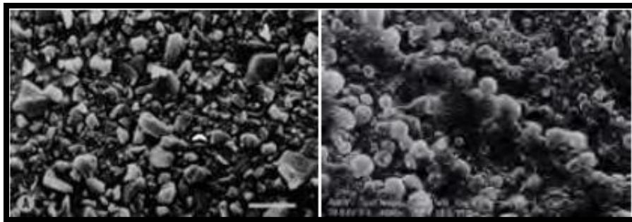
Imagen 14. Vista microscópica de Resina con microrelleno 2
