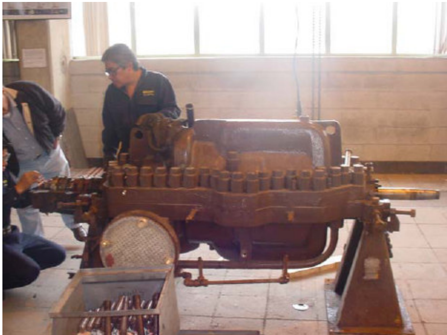
Figura 5.25 Carcasa con impurezas.
