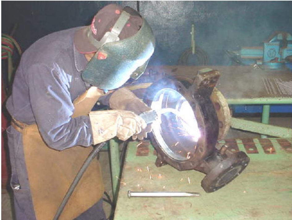
Figura 5.7 Recuperación de carcasa por soldadura.
