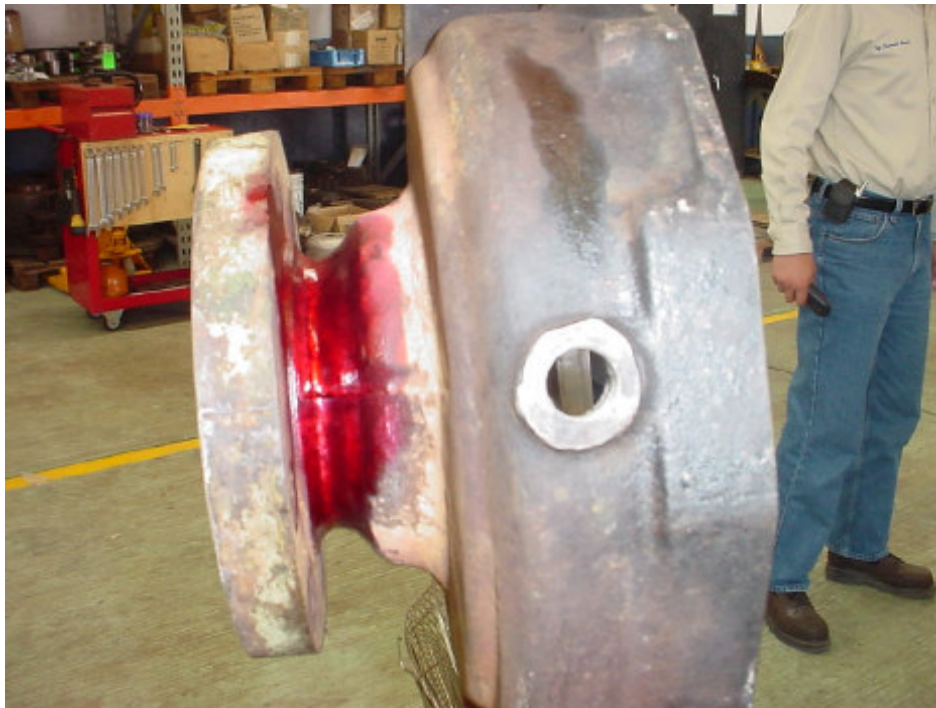
Figura 5.5 Prueba de líquidos penetrantes a carcasa.
