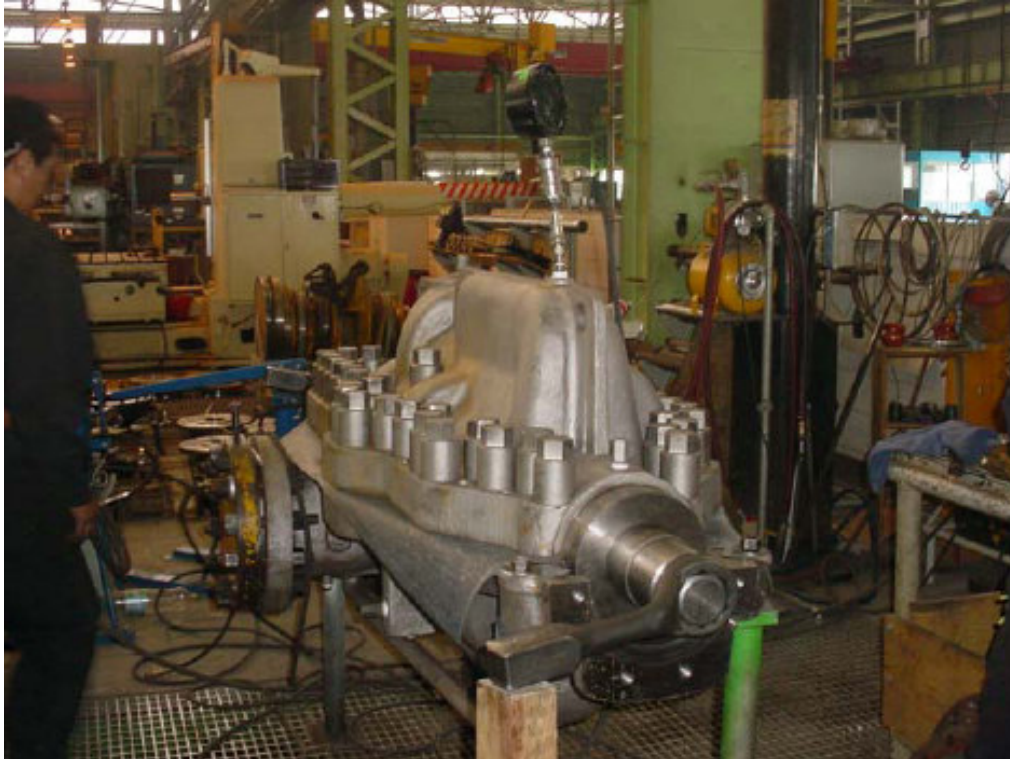
Figura 5.27 Carcasa sometida a prueba hidrostática.
