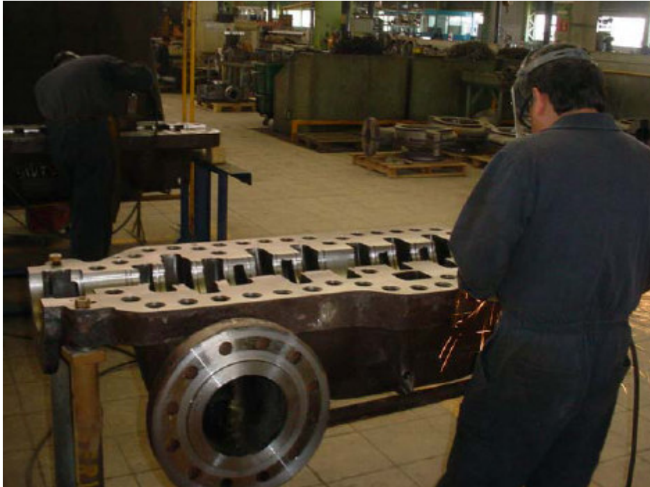
Figura 5.23 Limpieza de carcasa (rebabas).
