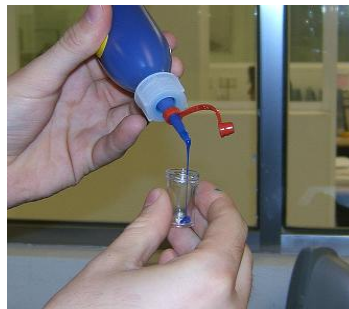
Figura 10. Adición de los componentes de la mezcla para la réplica de silicón
