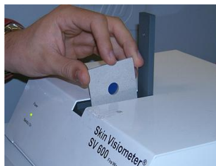
Figura 16. Forma de introducir el soporte en el Skin Visiometer SV 600
