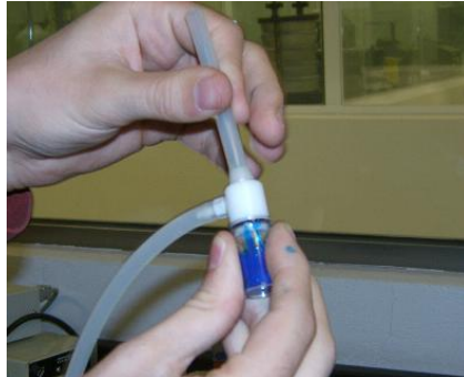
Figura 11. Preparación del silicón y agitación con bomba de vacío
