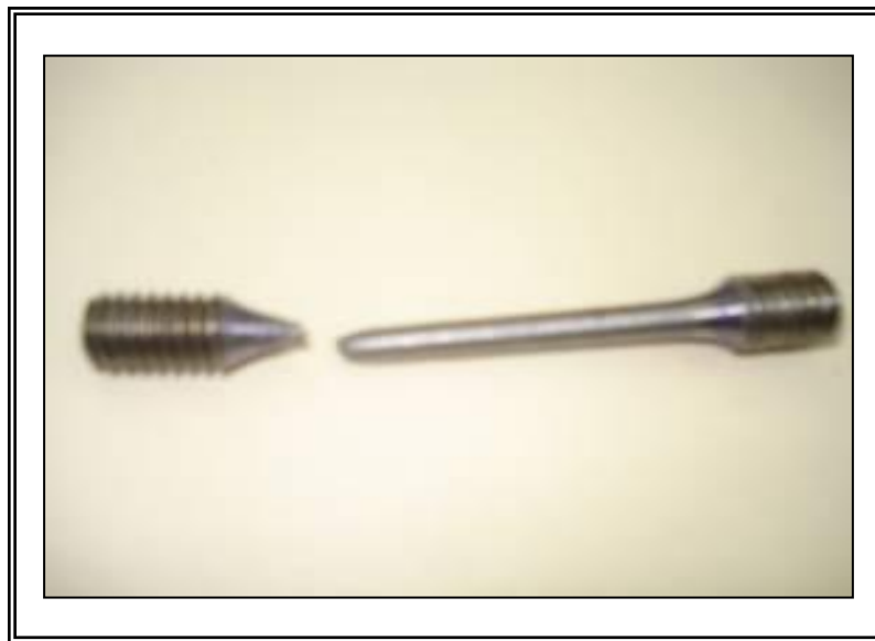
Figura III.4.1.1 Ejemplo de una probeta después de haber sido sometida a prueba de tensión de acuerdo al ASTM 305.
