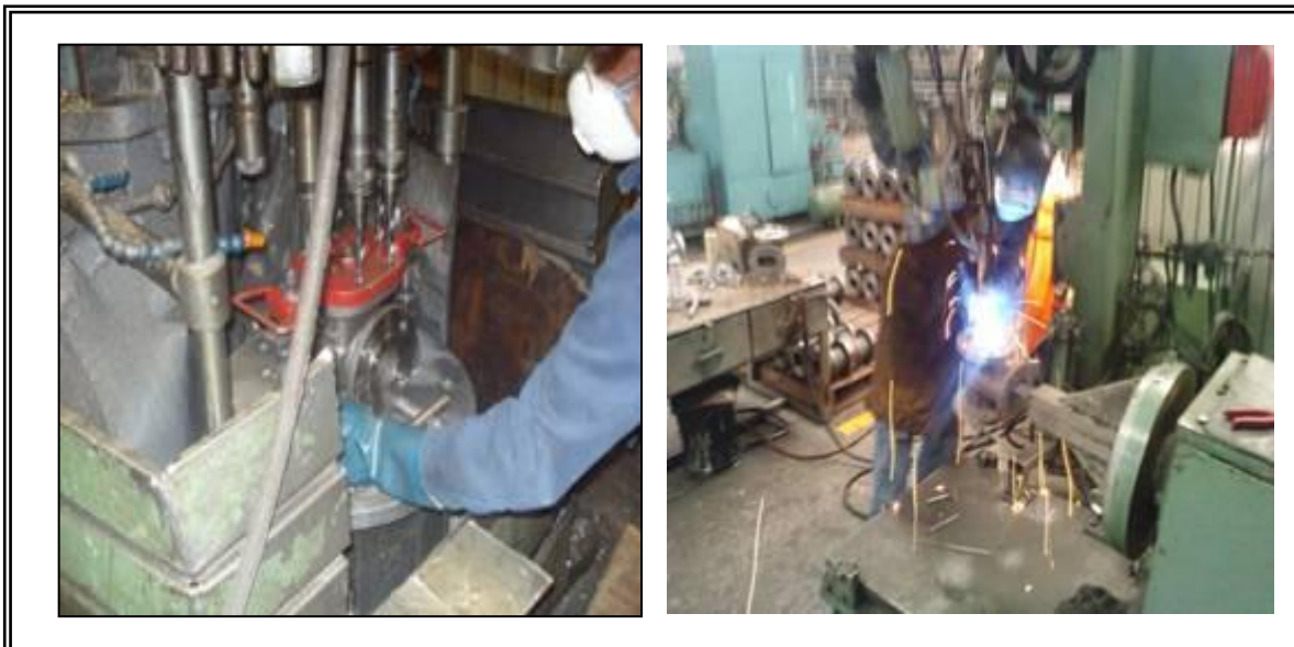
Figura II.2.3 Derecha: proceso semiautomático de soldadura, izquierda: proceso de barrenado de Bridas con taladro vertical.
