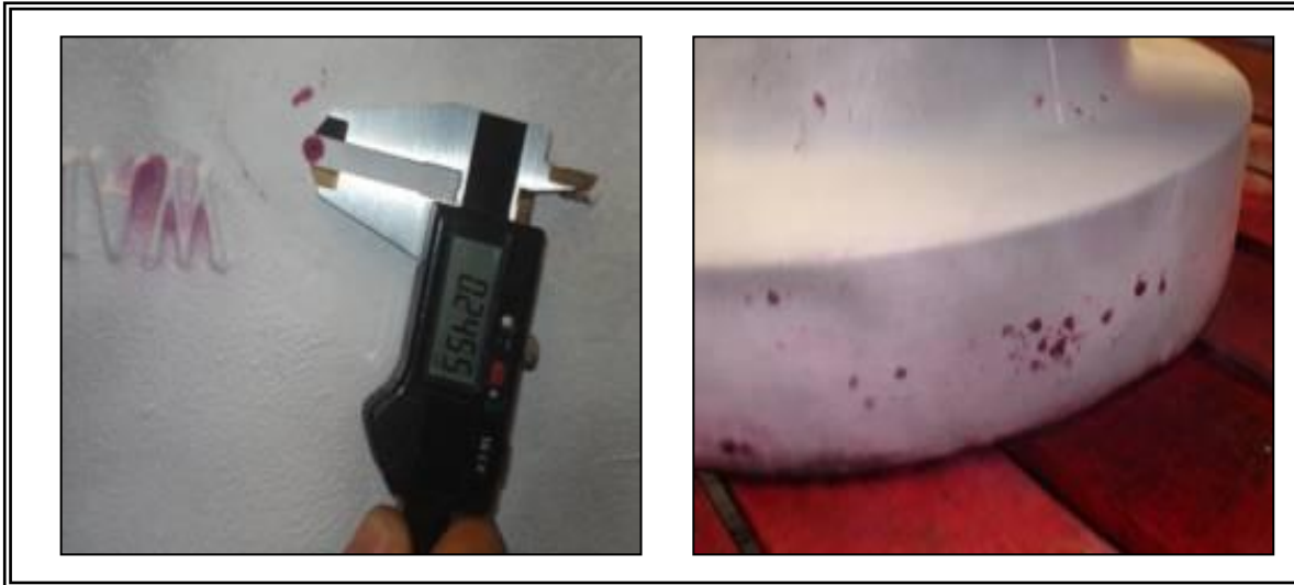
Figura III.3.2.3 Ejemplo de indicaciones no aceptables encontradas en fundición.
