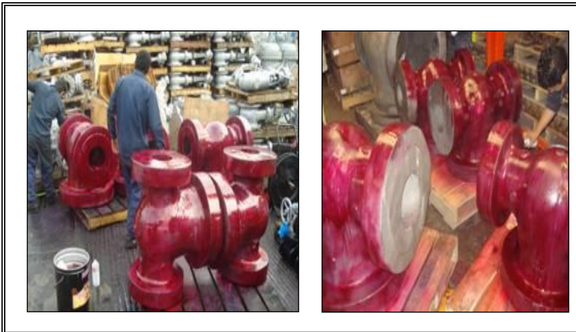
Figura III.3.2.2 Inspección por líquidos penetrantes base agua. Observé el tamaño de las piezas, ésta es una ventaja del proceso al poder remover el exceso del penetrante con agua.
