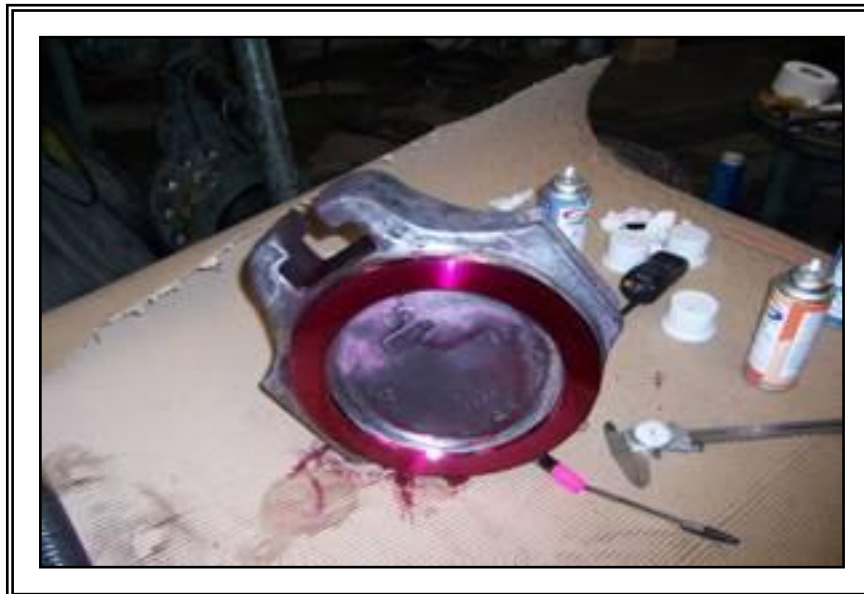
Figura III.3.2.3 Ejemplo de indicaciones no aceptables encontradas en fundición.
