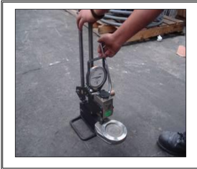
Figura III.1.3.1 Inspección de dureza de un disco con durómetro Brinell.
