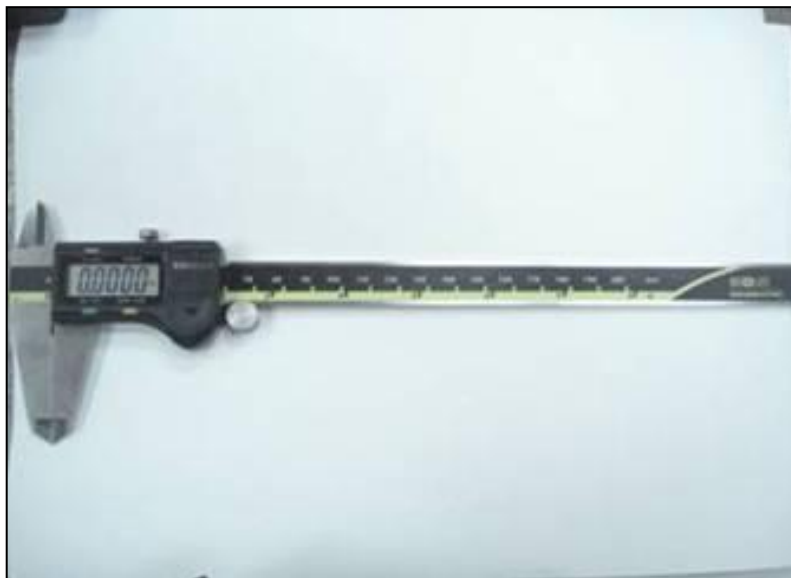
Figura III.2.1.1 Nonio o Vernier digital.
