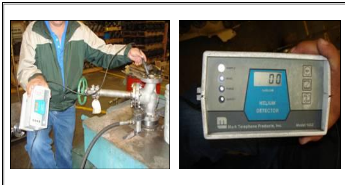
Figura III.3.3.1 Detector de helio empleado en las pruebas de emisiones fugitivas.
