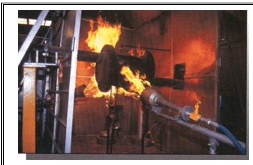
Figura III.4.3 Exposición a fuego directo de una válvula macho.
