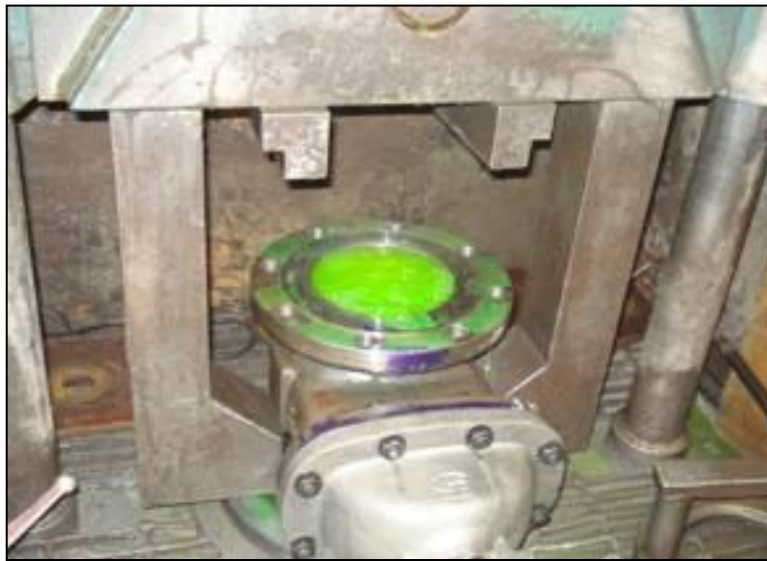
Figura III.3.4.1 Prueba neumática de una válvula compuerta.
