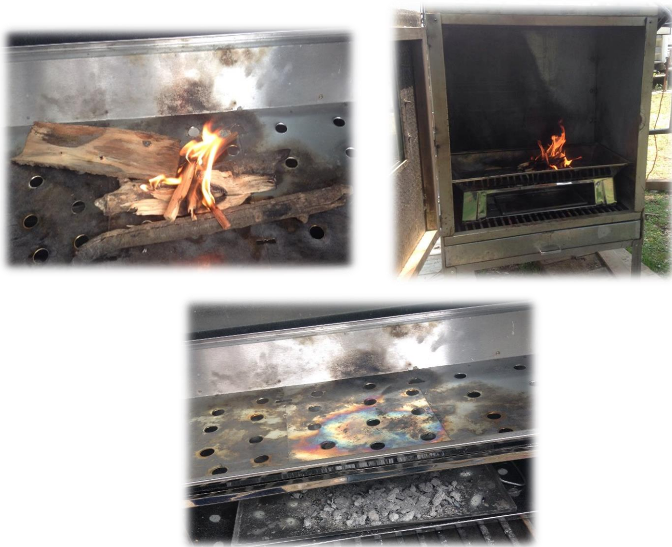
Figura 23 Procedimiento de la quema de biomasa, se colocó una muestra de residuo de encino (353 g) en la parrilla para la simulación de quema de biomasa El medio de ignición es el ocote y se inicia con la quema de la muestra Transcurridos los 15 minutos (tiempo en el que tarda en quemarse toda la muestra), podemos observar los residuos
