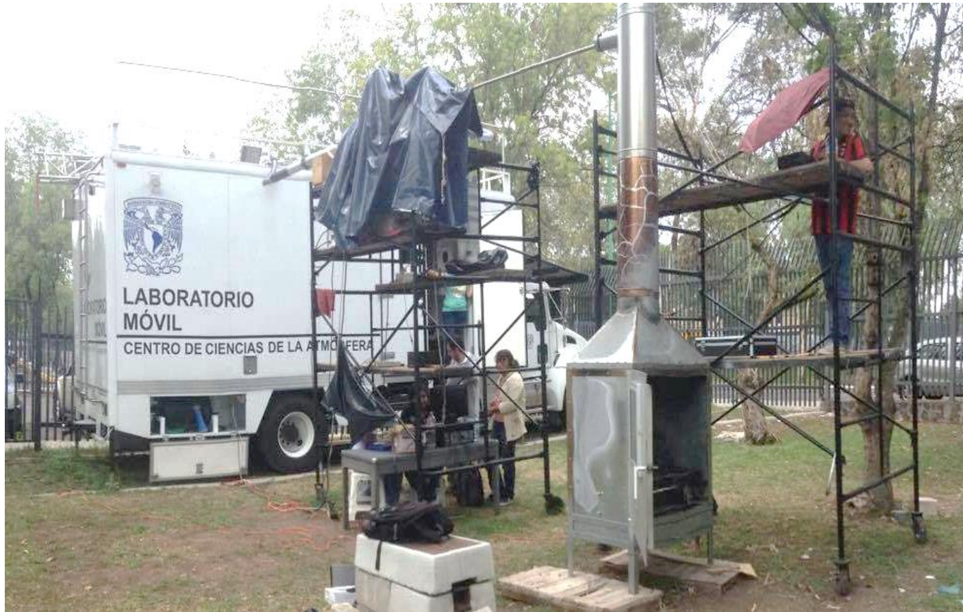
Figura 9 Acoplamiento de los tres conjuntos de equipos a utilizar; Cámara de combustión--- Cámara de dilución--- Laboratorio móvil.
