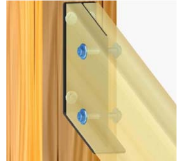
Unión de viga estructural de madera con elemento estructural de madera con pernos y placa de acero
