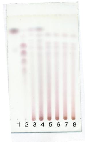
Figura 26. Placa de la cromatografía en placa fina de los sobrenadantes de E. faecium después de 24 h de incubación. 1) Estándar de Fru:Glu: Sac (10 g/L) + Inulina de Leuconostoc (4 g/L), 2) Estándar FOS Orafti®P95 (5 g/L), 3) Agavina microfiltrada (5 g/L), 4) MRS modificado, 5) Sobrenadante E. faecium cepa I3G anaerobiosis, 6) Sobrenadante E. faecium cepa I3A anaerobiosis, 7) Sobrenadante E. faecium cepa I3G aerobiosis, 8) Sobrenadante E. faecium cepa I3A aerobiosis.
