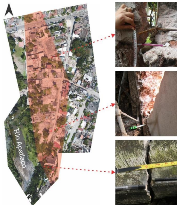
Figura 5.3. Fotografías donde se observan los registros de desplazamientos laterales izquierdos señalados por una línea punteada en color rojo ubicados en el mosaico de fotografías aéreas donde el polígono en color rojo indica la franja de viviendas afectadas por el agrietamiento en el suelo.
