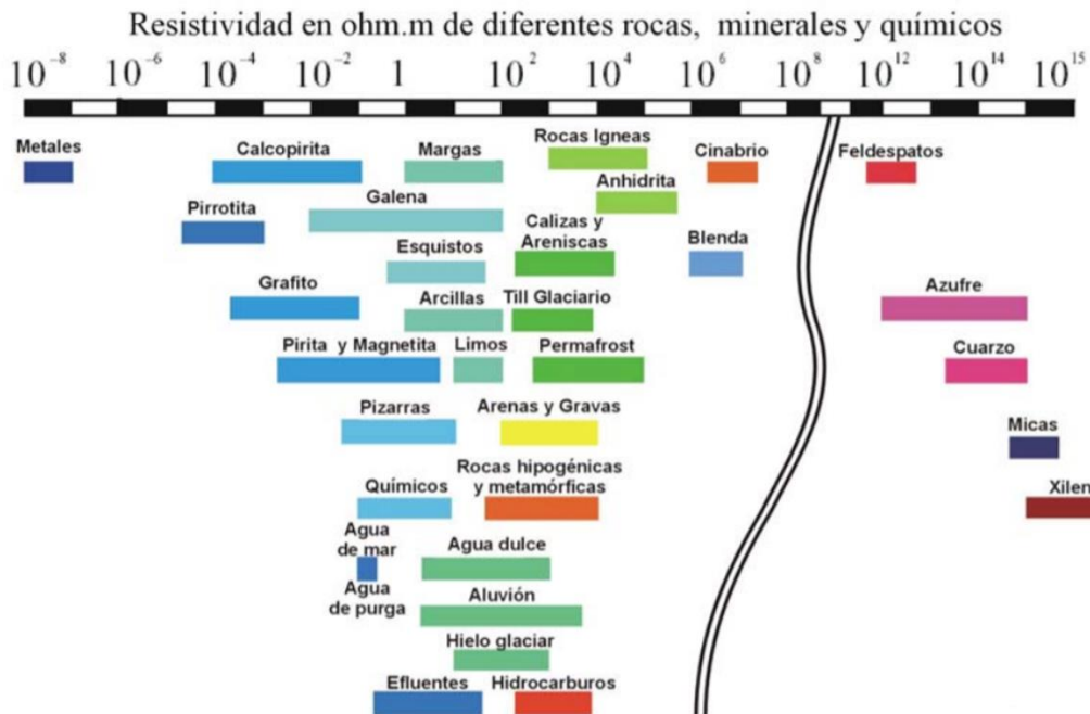
Figura 5.6. Esquema de valores de resistividad eléctrica para distintos materiales y tipos de roca. Tomada de Ávila-Vargas, (2019).
