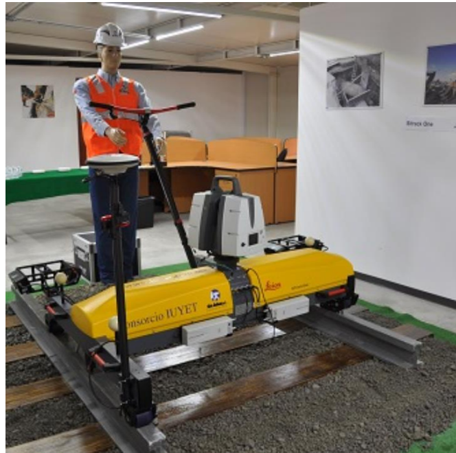
Figura IV-18 Escáner utilizado por IUYET para modelar el terreno. 66
