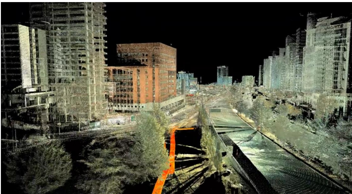
Figura IV-19 Nube de puntos obtenida al escanear el tramo en cuestión. 66
