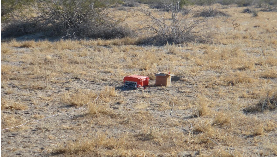
Figura 4.5 – Consola ADU-07e instalada en campo.
