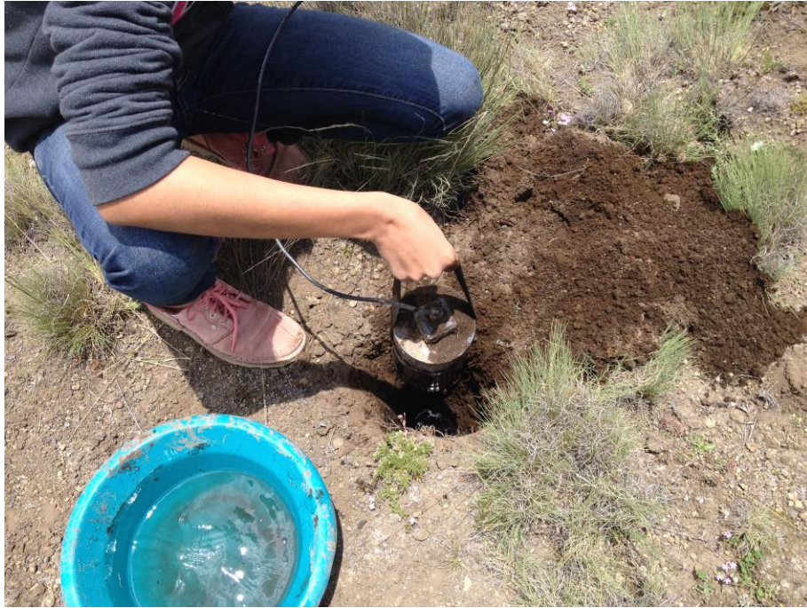
Figura 4.4 – Colocación de un electrodo en campo.
