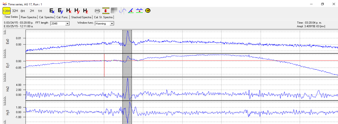
Figura 4.6 – Ruido local afectando a los campos eléctricos y magnéticos.
