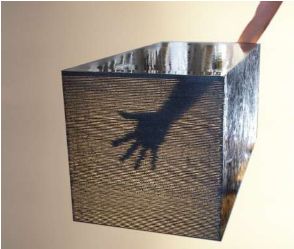
Concreto traslúcido Litracon http://www.codeen.es/materiales/
