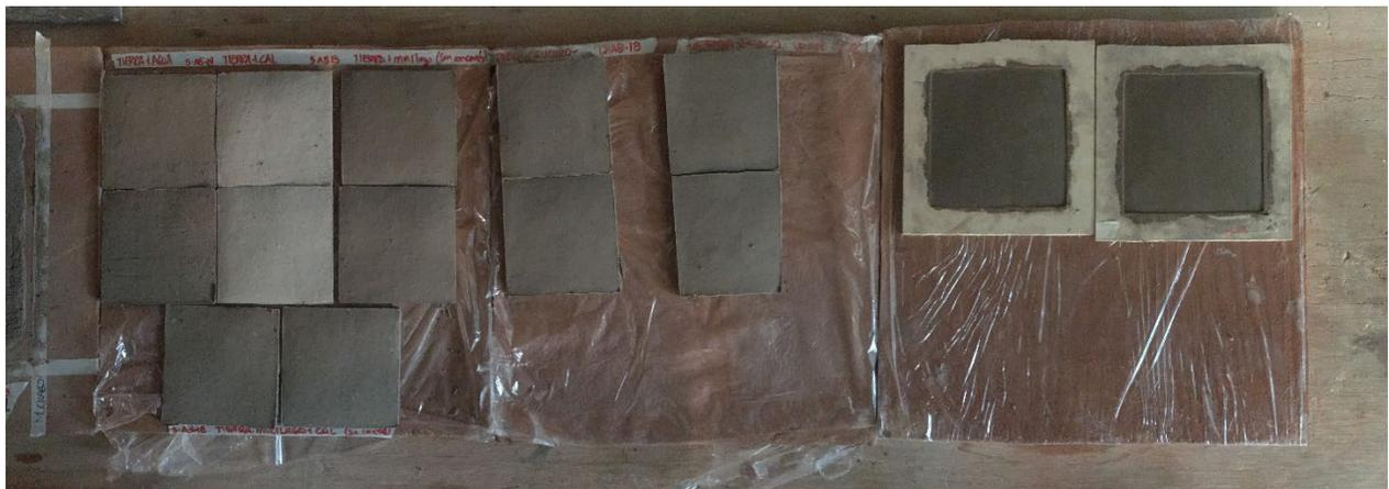
**Figura 74.** Probetas de tableta de 10 cm x 10 cm x 0.5 cm durante su proceso de secado. El periodo de secado fue de 14 días. Fuente: Esmeralda Avila, abril del 2018.
