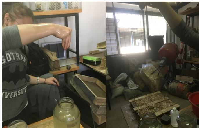
**Figura 62.** Izquierda, prueba del hilo para determinar la viscosidad del mucílago. **Figura 63.** Derecha, elevación del hilo para medir viscosidad. Fuente: Esmeralda Avila 2017.
