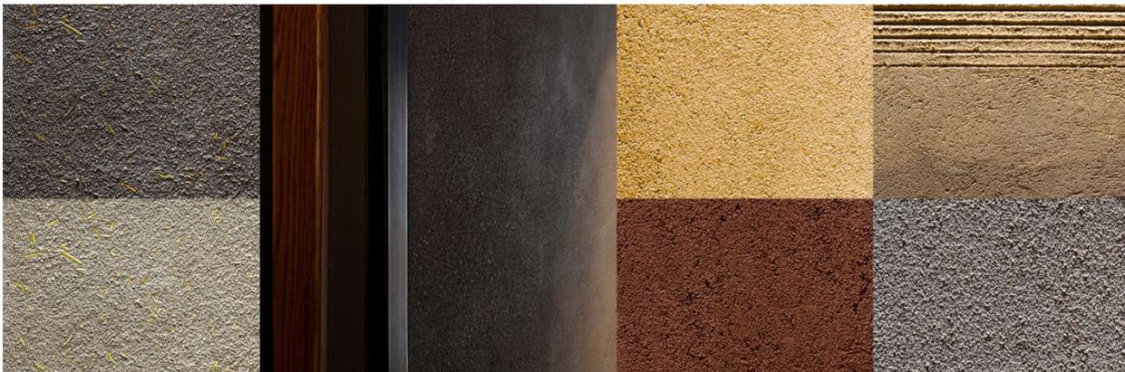
**Figura 25.** Texturas del acabado rugoso arakabe y el acabado fino shikkui. Fuente: [www.kusuminaoki.com](http://www.kusuminaoki.com).
