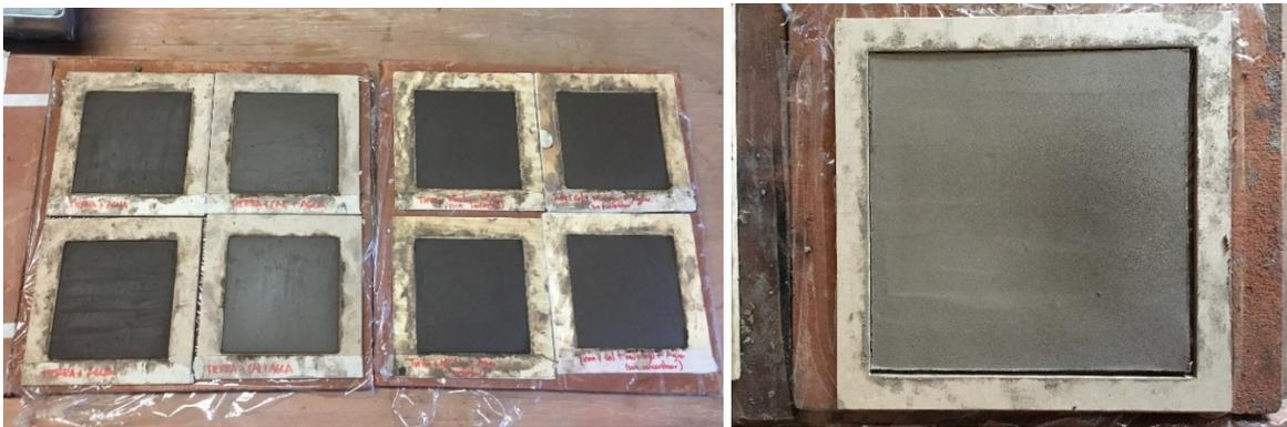
**Figura 67.** A la izquierda, probetas de tableta de 10cm x 10cm durante su proceso de secado, a la derecha, probeta de tableta de 20cm x 20cm al término de su secado. Fuente: Esmeralda Avila (abril del 2018)
