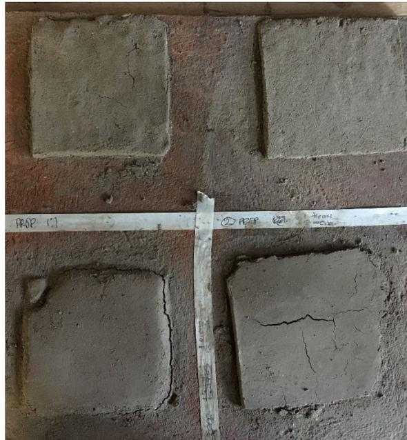
**Figura 58.** Ensayo de retracción y expansión para observar el patrón de agrietamiento de las mezclas de tierra con diferentes proporciones de arena. Fuente: Esmeralda Avila Boyas
