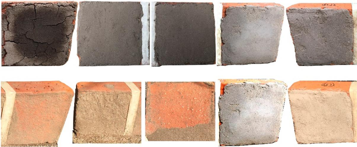
**Figura 84.** Probetas de revoque sobre ladrillo. Parte superior, se muestra el comportamiento pasadas un par de horas después de su aplicación. Parte inferior, se muestra el comportamiento pasados 90 días después de estar sometidas al clima de verano con un alto índice de lluvias. Fuente: Esmeralda Avila (agosto del 2018)
