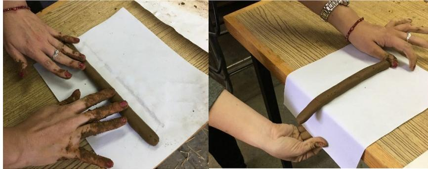
Figura 56. Ensayo de cohesión de la muestra de tierra utilizada para la fase experimental. Fuente: Luis Guerrero, 2017.
