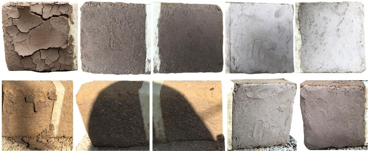
**Figura 83.** Probetas de revoque sobre adobes. Parte superior, se muestra el comportamiento pasadas un par de horas después de su aplicación. Parte inferior, se muestra el comportamiento pasados 90 días después de estar sometidas al clima de verano con un alto índice de lluvias. Fuente: Esmeralda Avila (agosto del 2018)
