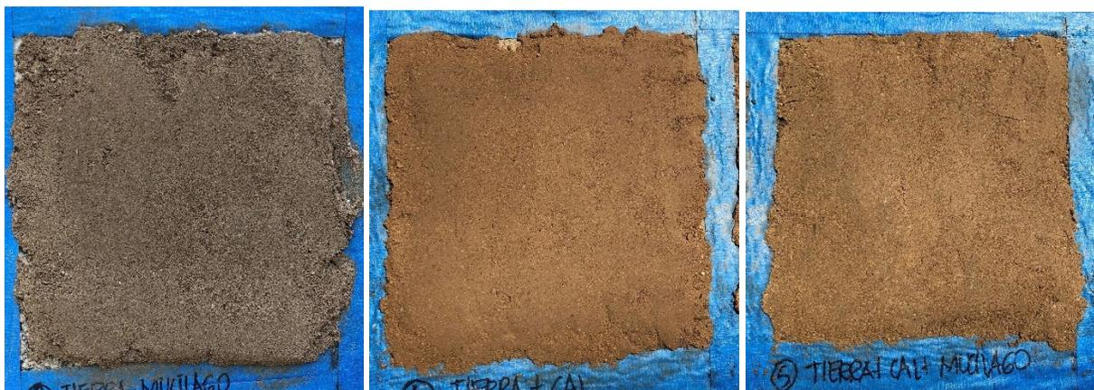
**Figura 82.** Probetas que presentaron una mejor trabajabilidad y manejabilidad al ser aplicadas. De izquierda a derecha, mezcla 3 tierra-arena-mucílago, mezcla 4 tierra-arena-cal y mezcla 5 tierra-arena-cal-mucílago. Fuente: Esmeralda Avila, junio del 2018.
