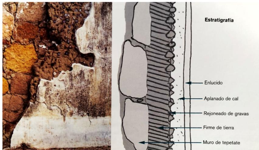
Figura 36. Esquema de la estratigrafía más común en los muros de Cacaxtla. Fuente: (Gonzalez, 2013, pág. 215)
