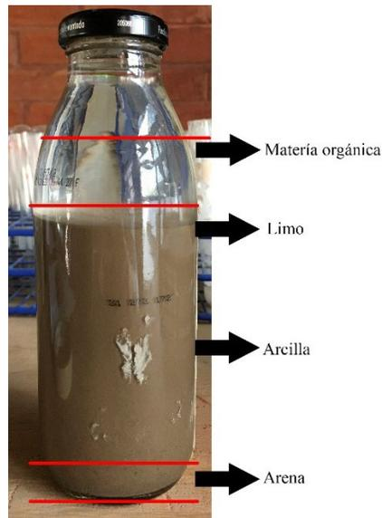
**Figura 55.** Resultado del ensayo de sedimentación. Se pudo notar a primera instancia el alto contenido de arcilla del material. Fuente: Archivo propio de la autora, 2017.
