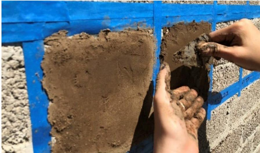
**Figura 64.** Aplicación de probeta de revoque sobre una superficie de bloques de cemento. Fuente: Esmeralda Avila (agosto del 2018)
