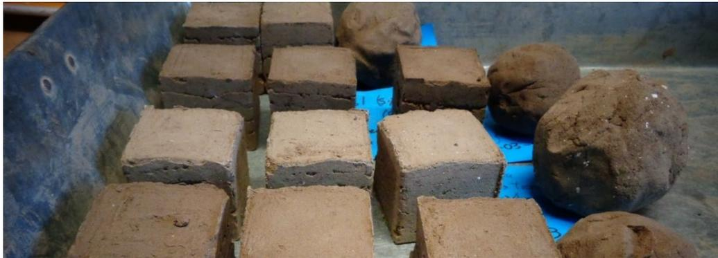
**Figura 66.** Probetas cúbicas después del periodo de secado, ENCRYM, Ciudad de México. Fuente: Esmeralda Avila (12 de abril del 2018)
