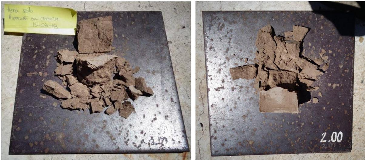
**Figura 71.** A Izquierda. Muestra 1 correspondiente a la mezcla de tierra-agua, a la derecha, muestra 4 correspondiente a la mezcla tierra-arena-agua-cal, ambas después de ser sometidas a una carga axial para determinar su resistencia a la compresión. Fuente: Esmeralda Avila, 18 de mayo del 2018.
