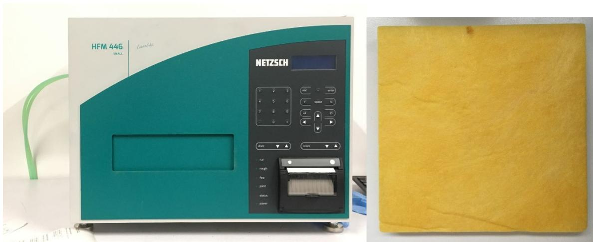
**Figura 73.** Medidor de flujo de calor y material utilizado como patrón de calibración del equipo, ambos componentes utilizados para los ensayos de conductividad térmica. Fuente: Esmeralda Avila. Mayo del 2018.
