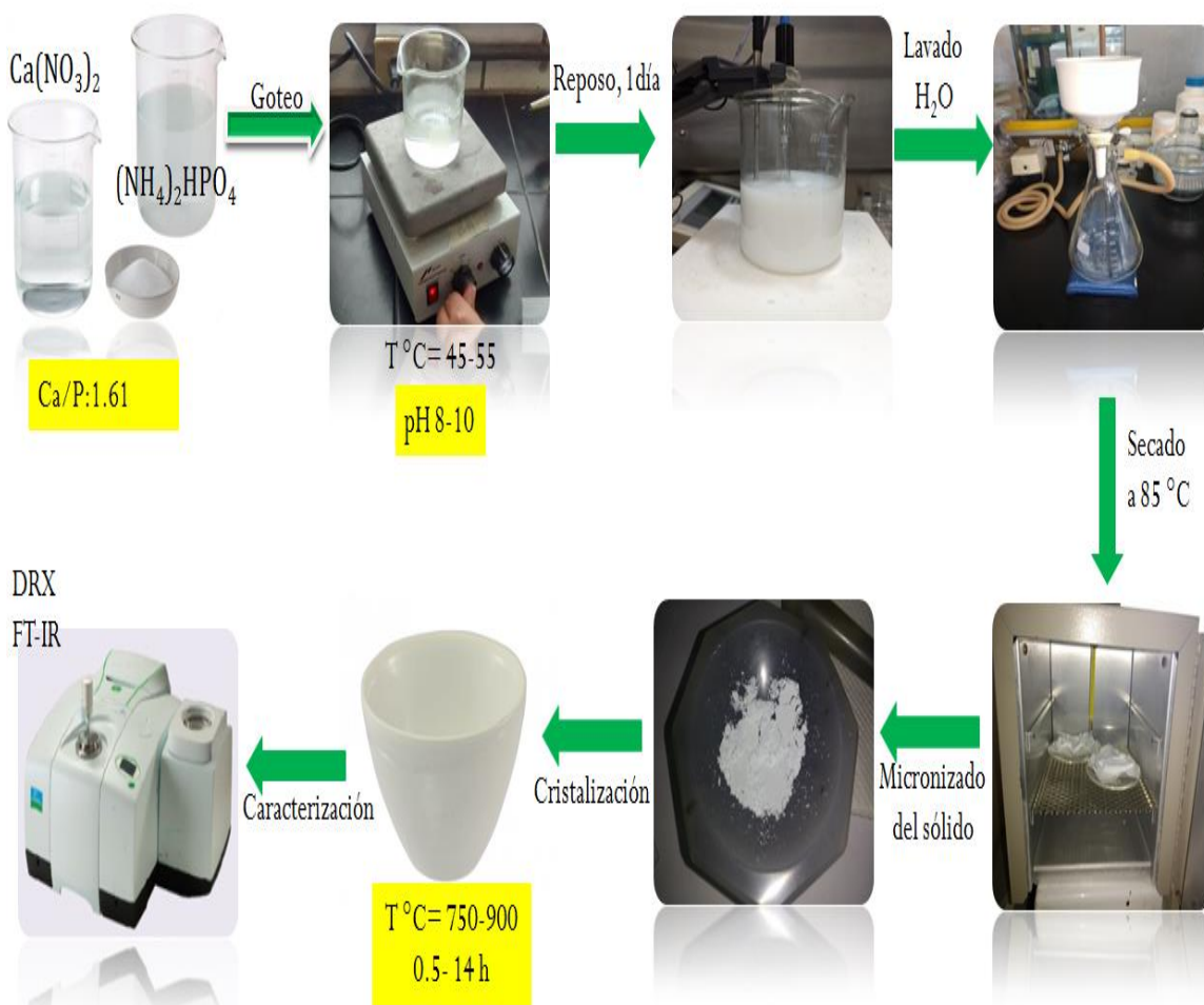
Figura 5. Metodología para la síntesis de BCP por el método de coprecipitación.
