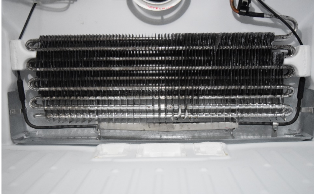
Figura A.9: Fotografía de un evaporador comúnmente encontrado en los sistemas de refrigeración domésticos y comerciales.
