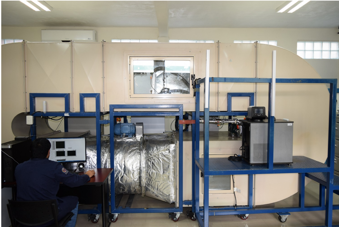
Figura 3.2: Fotografía del calorímetro tipo túnel de viento utilizado durante la investigación.
