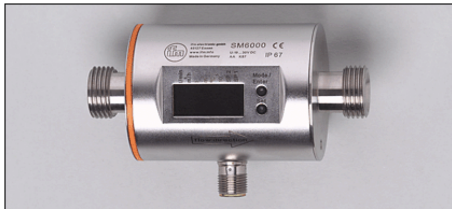
Figura A.4: Fotografía del flujómetro SM6000 utilizado para registrar el caudal del refrigerante.
