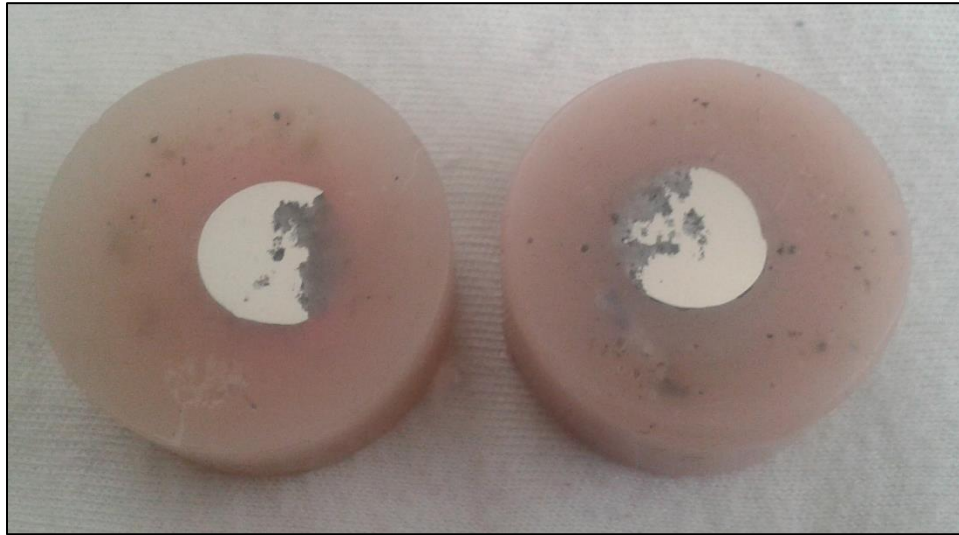
Figura 14. Piezas desbastadas parcialmente para evitar destruir la evidencia de la fractura y observar la interface fractura-pieza pulida.
