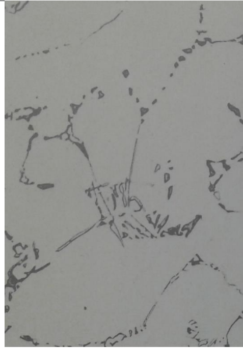
Figura 29. Aleación con 7% Mg, 1.5% Si, 0.2% Mn, 0.3% Fe en molde de arena a 250X. Mg 2 Si en negro, FeAl 3 y Mg 5 Al 8 en gris oscuro y gris claro respectivamente.
