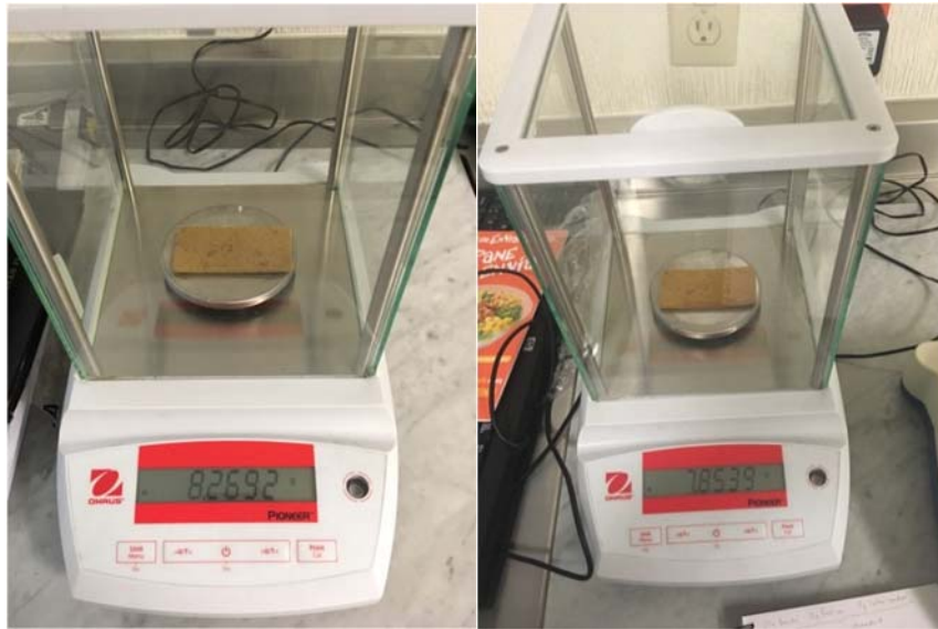
Fotografías tomadas durante el pesaje de la probeta #2. Antes vs después de la exposición Se pesaron las probetas antes y después del ensayo y se obtuvieron los siguientes valores:
