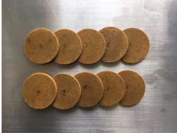
Probetas de absorción de humedad previo al secado.
