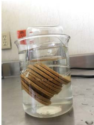
Inmersión de probetas en agua destilada durante dos horas
