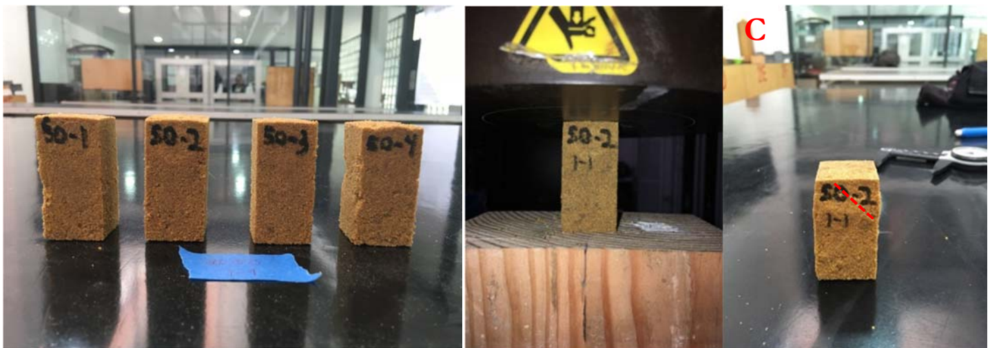
Imagen de probetas de relación 1:1, fibra tamizadas con la malla #50. Antes y después de la prueba como ejemplo la probeta #2.
