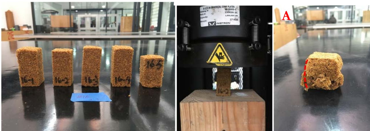
Imagen de probetas de relación 1:1, fibra tamizadas con la malla #16. Antes y después de la prueba como ejemplo la probeta #2.
