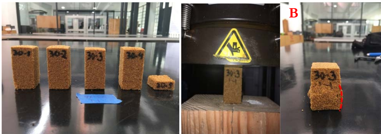
Imagen de probetas de relación 1:1, fibra tamizadas con la malla #30. Antes y después de la prueba como ejemplo la probeta #3.
