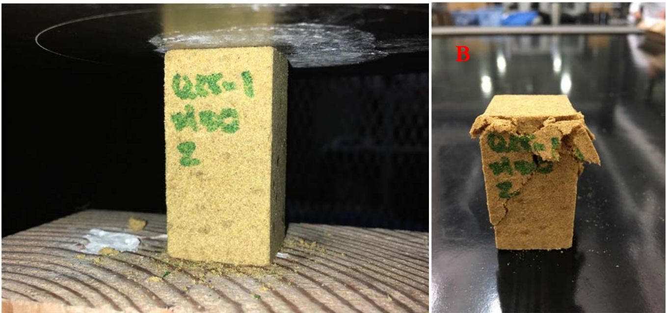
Imagen de probetas de relación 1:0.25, fibra tamizadas con la malla #50. Antes y después de la prueba como ejemplo la probeta #2.
