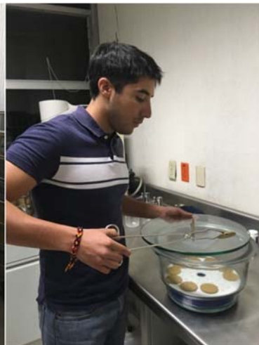
colocación de probetas en la desecadora
