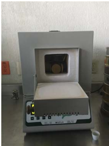
Inserción de probetas en la mufla
