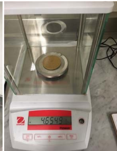
pesaje de probetas posteriores al secado
