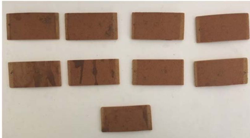
Probetas de intemperismo acelerado después de ser expuestas a intemperismo según la norma astm g154.
