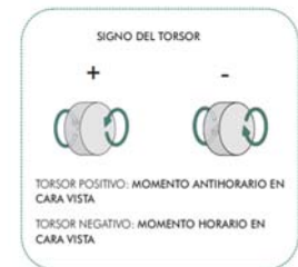
Esfuerzo de Torsión. Imagen recuperada de Tema 4: Esfuerzos y Solicitaciones, Estructuras, Universidad de Sevilla
