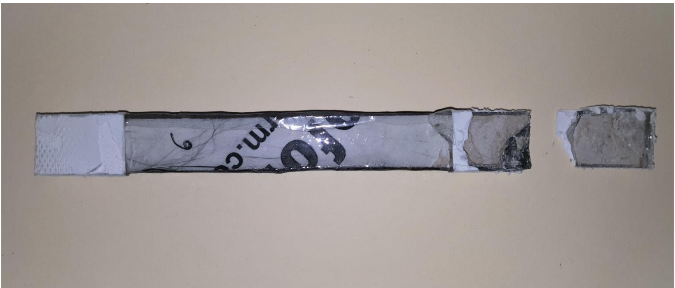
Figura X27. Espécimen de prueba ET2-CF-06. Las fallas por rotura de los especímenes tipo ET2-CF-n se presentaron dentro de los extremos de sujeción de las mordazas, por la delaminación entre capas de la fase matriz de cartón.
