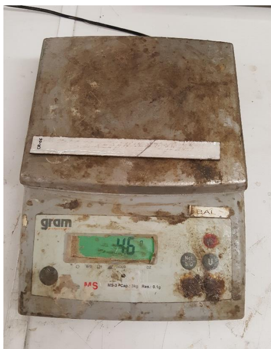
Figura X12. Pesaje de muestra ET2-CR para ensayo de esfuerzos a tensión con báscula digital en área de laboratorio LITEM, UPC.
