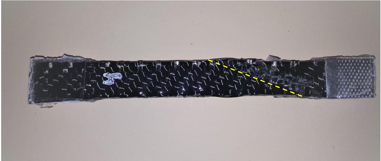
Figura 82. Espécimen de prueba ET2-CF-04. A la derecha se observa la rotura de fibras de carbono individuales aleatorias en el tejido en forma diagonal, denotando la transmisión del esfuerzo a la capa de refuerzo.
