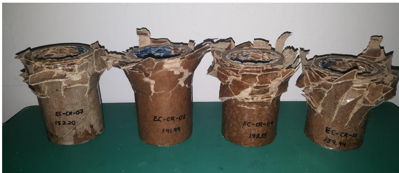
Figura 46. En los especímenes EC1-CR-07, EC1-CR-08, EC1-CR-09 y EC1-CR-10 fueron sometidos a una mayor duración del ensayo, observando un reacomodo de las capas del material por el aplastamiento de plegado continuo a lo largo del eje axial.
