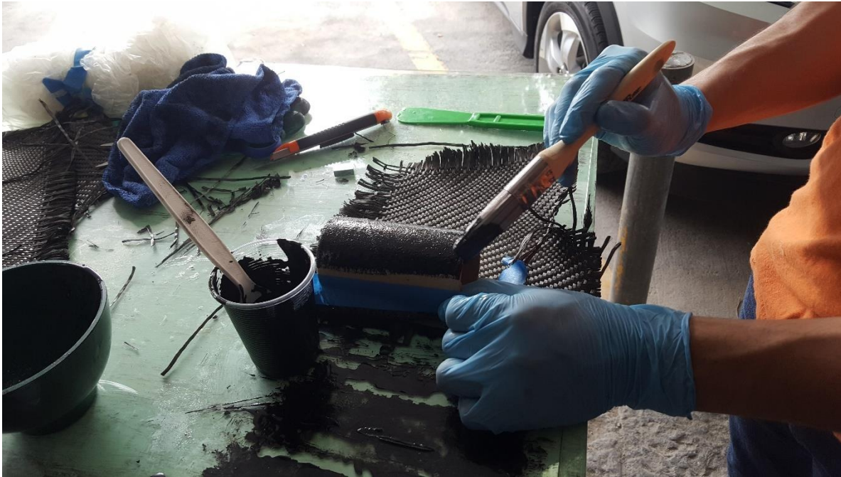
Figura 23. Ejemplo de aplicación de resina epóxica en material compuesto del proyecto de investigación.
