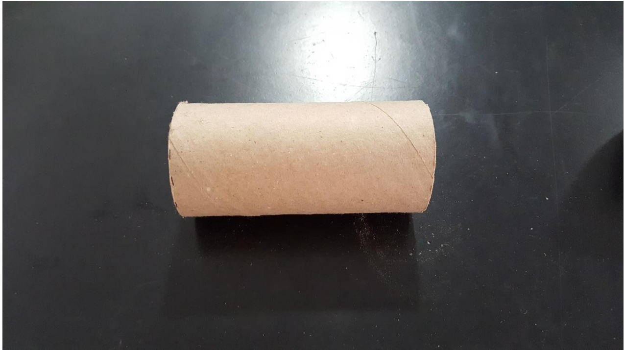
Figura B3. Obtención de espécimen de prueba tipo EC para ensayo a esfuerzos de compresión, previo al proceso de lijado.
