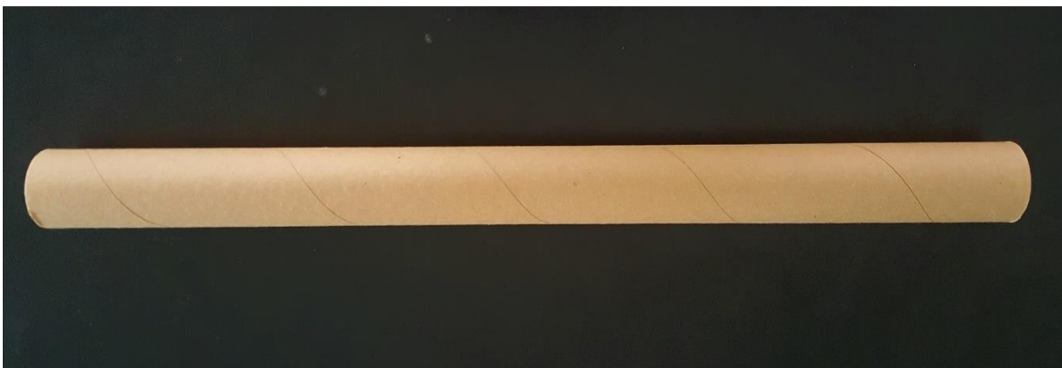
Figura B1. Tubos de sección cilíndrica compuestos por cartón Kraft, utilizados como fase en los especímenes de prueba.
