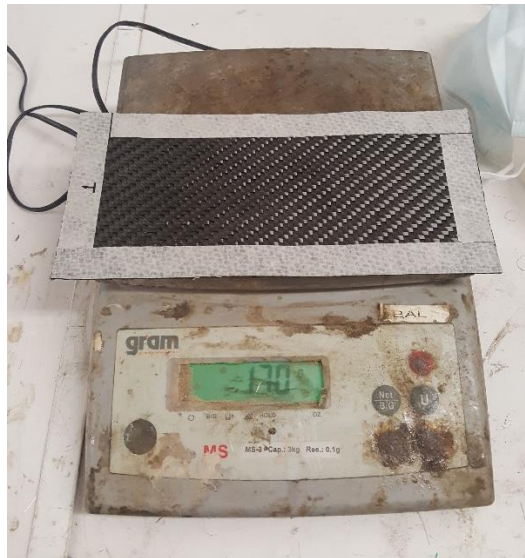
Figura X14. Pesaje de capa del tejido de fibras de carbono para los especímenes de prueba, con báscula digital en área de laboratorio LITEM, UPC.
