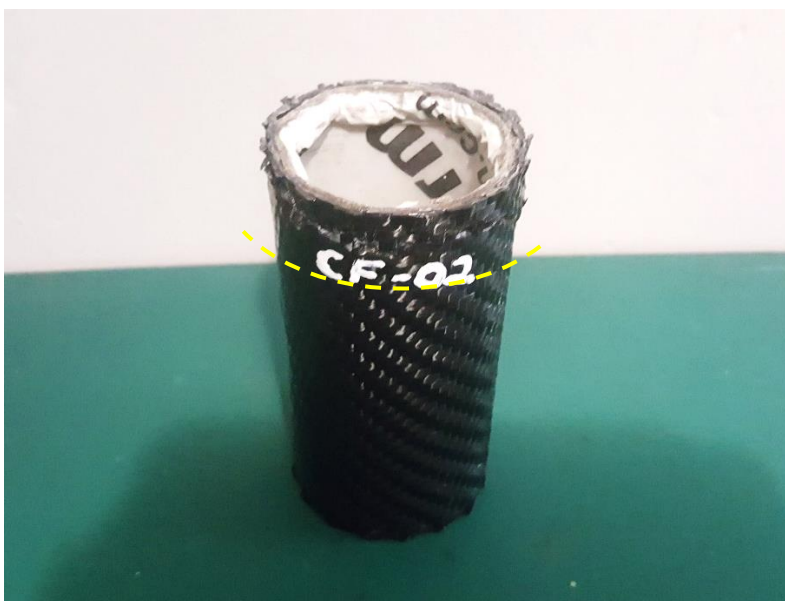
Figura X38. Especímen de prueba EC2-CF-02. Debido a la elevada rigidez del material compuesto, el elemento presenta escasa deformación. Al interior del tubo se observa la deformación de la fase matriz de cartón que sirve como base para el tejido de fibras de carbono.
