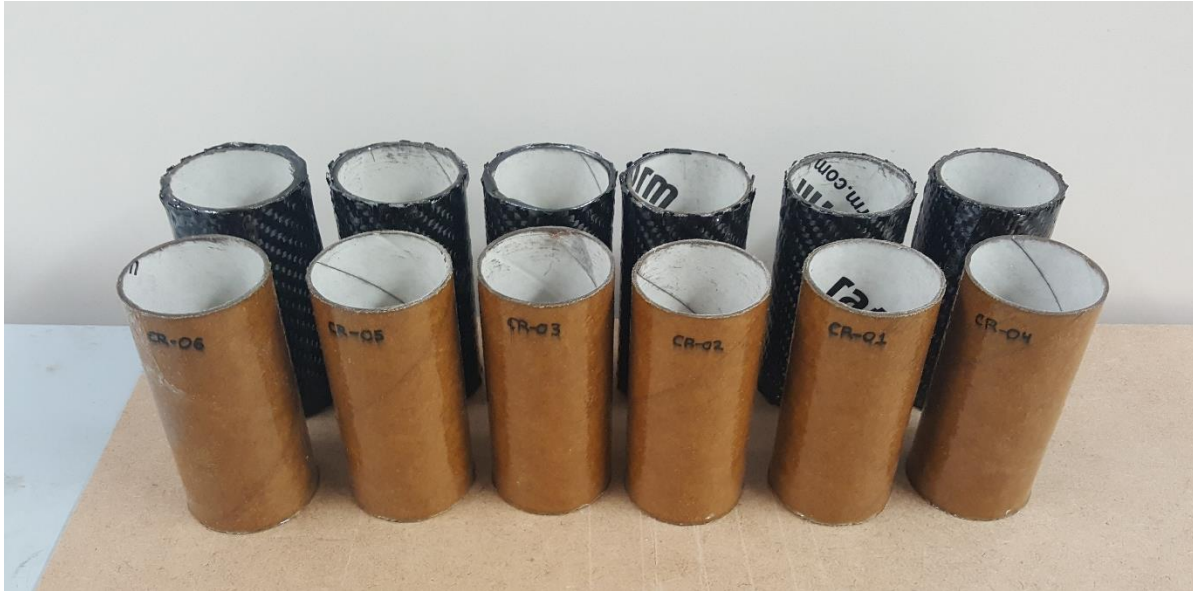
Figura X30. Muestreo de especímenes de prueba EC-CR-n y EC-CF-n, para ensayo de esfuerzos a compresión EC2.
