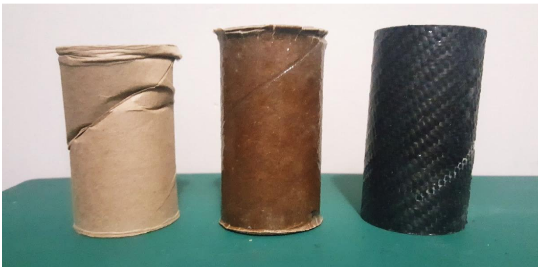
Figura 57. Comparación de especímenes de prueba EC1 de las tres variables experimentadas, posterior al ensayo a esfuerzos de compresión.
