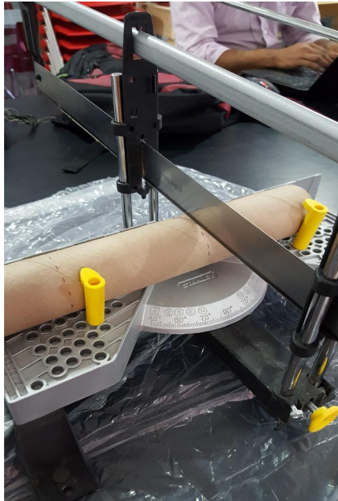
Figura B2. Colocación de marcas en tubo cilíndrico para posterior corte de especímenes de prueba.
