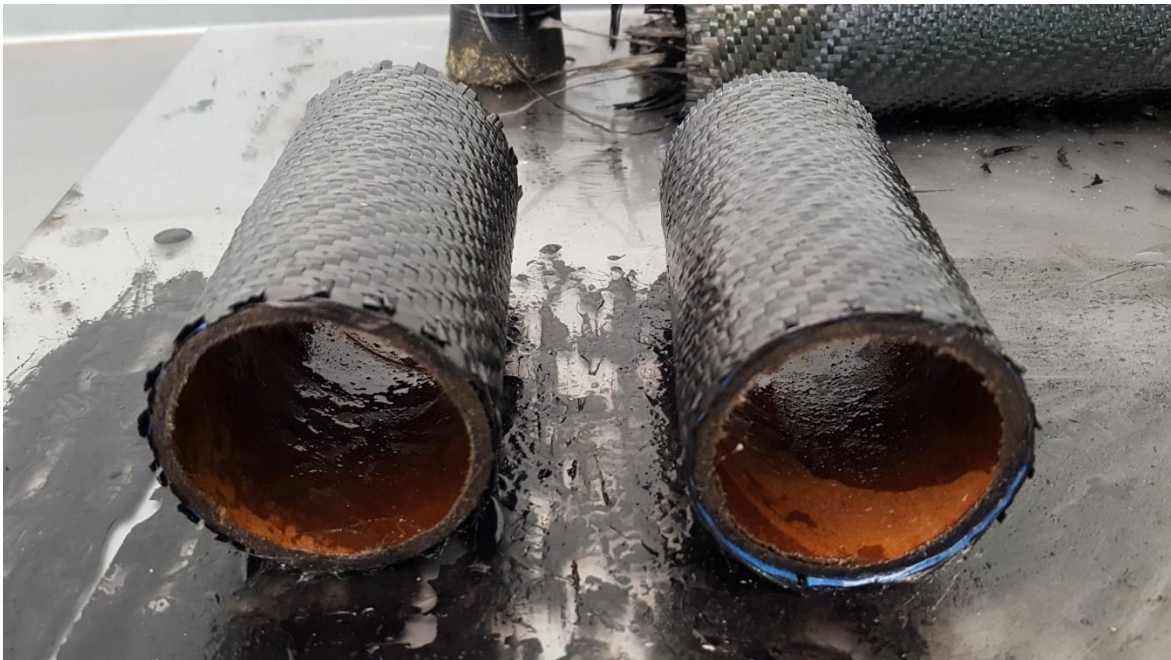
Figura 32. Vista de sección de especímenes de prueba EC1-CF-n, para el ensayo de resistencia a esfuerzos de compresión.
