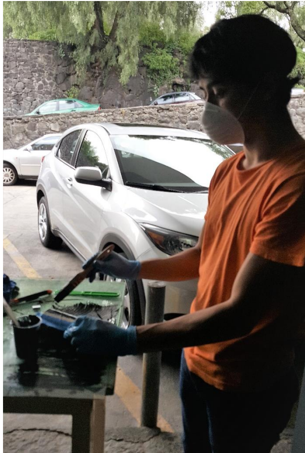
Figura B7. Aplicación de resina epóxica con brocha de 1" sobre especímenes de prueba EC-CR-n.
