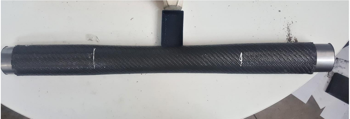
Figura 79. Especimen de prueba ET1-CF-01. Se observa el uso de rellenos metálicos en los extremos de sujeción para evitar la deformación ejercida por las mordazas. Así mismo, se vislumbra la deformación resultante de tipo dúctil del espécimen tras la realización del ensayo.
