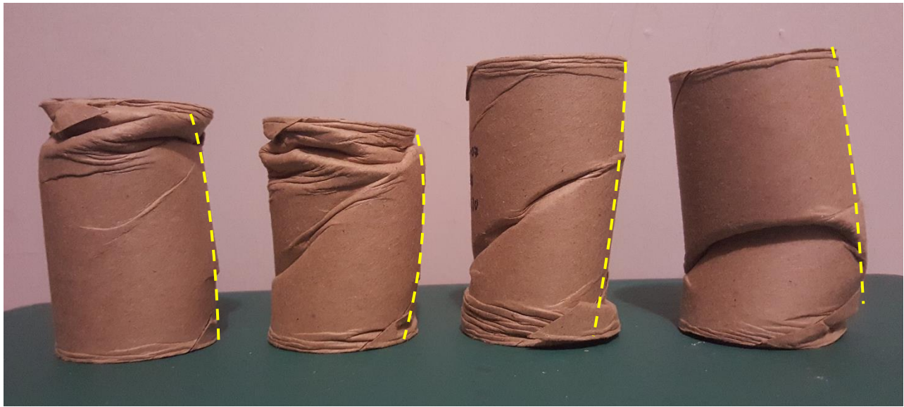
Figura 37. Los especímenes de prueba EC1-CA-03, EC1-CA-05, EC1-CA-07 y EC1-CA-09 obtuvieron la mayor resistencia en el ensayo; se observa que en el comportamiento de estos elementos se distribuyó la carga uniforme sobre el eje axial, generando un pandeo global del elemento hasta que se produjo la falla debido a las uniones del devanado multicapa helicoidal.
