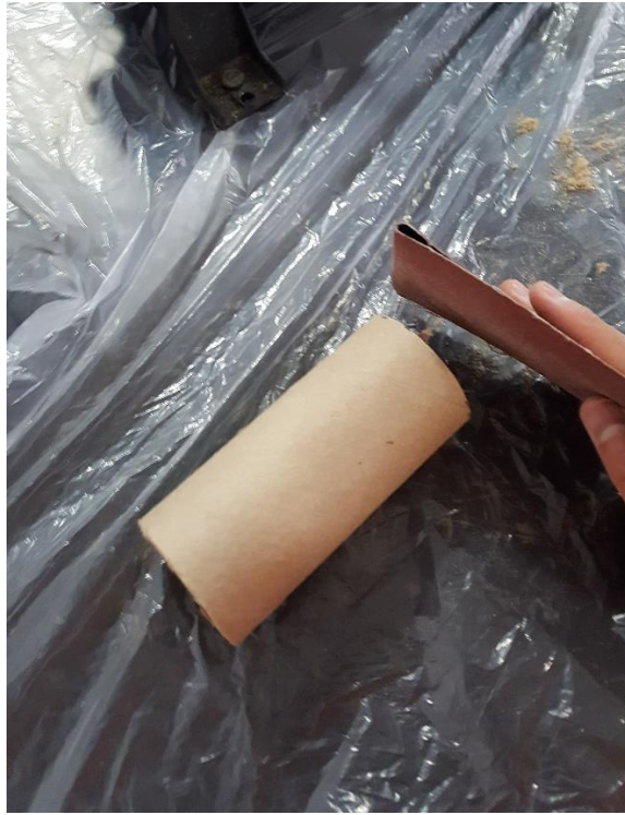
Figura B4. Proceso de lijado con lijas de agua en especímenes de prueba tipo EC.
