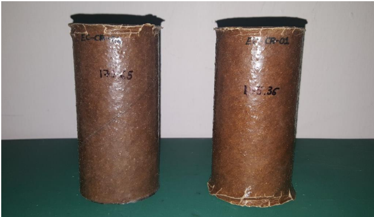
Figura 42. Especímenes ECI-CR-01, ECI-CR-02. La adición de la resina epóxica como recubrimiento aumentó la rigidez de los elementos, permitiendo una transmisión de esfuerzos sobre el eje axial más eficiente y, una menor deformación y aplastamiento.
