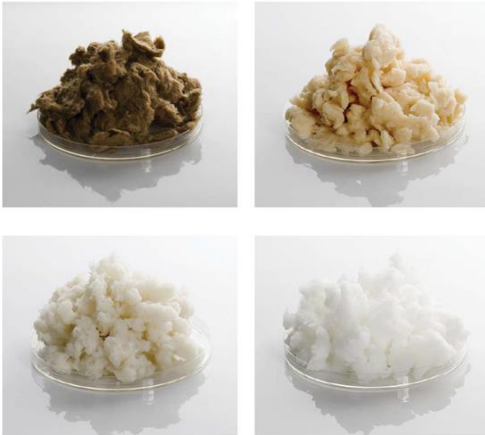
Figura 9. Ejemplo de grados de blanqueo de pulpa de celulosa (Iggesund Paperboard, 2017).
