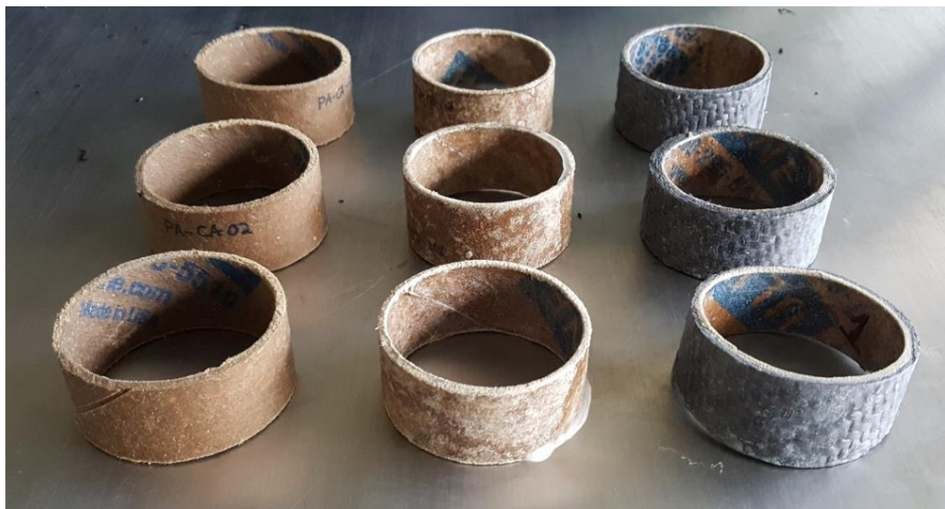
Figura 112. Especímenes de prueba tras ensayo de absorción de humedad, tres variables (H-CA-n, H-CR-n, H-CF-n). Se observa el ligero oscurecimiento de las especímenes de prueba de la Variable 1 por la presencia de agua en el material.
