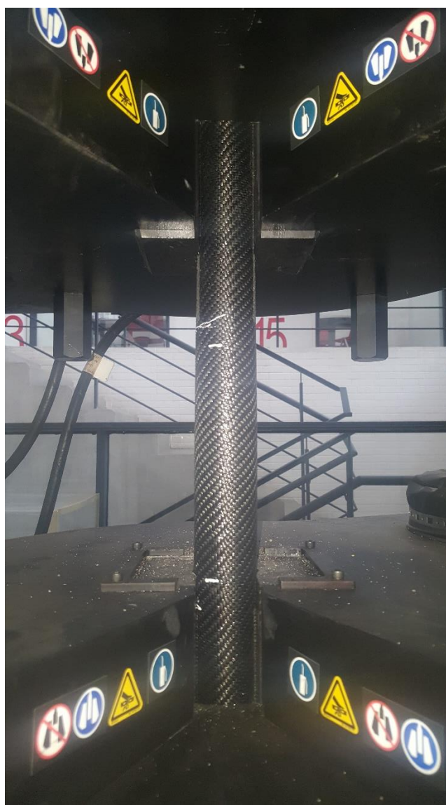
Figura 78. Espécimen de prueba ET1-CF-01. Al realizar el ensayo a esfuerzos de tensión, se observa la deformación del espécimen de prueba por la presión ejercida de la máquina de pruebas universales.
