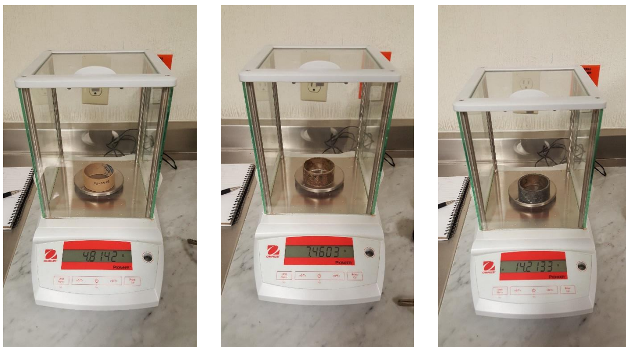
Figuras 108 – 110. Pesaje de especímenes en instrumento de medición, posterior a proceso de secado (H-CA-n, H-CR-n, H-CF-n).
