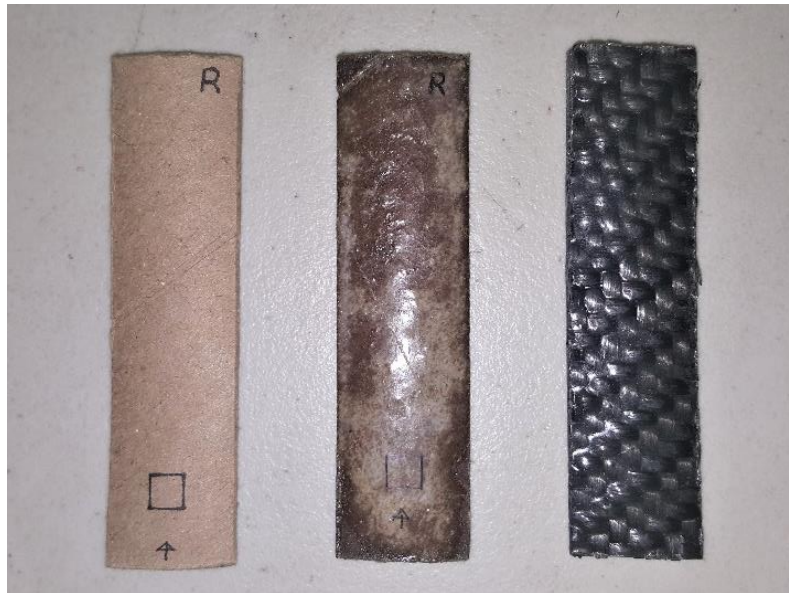
Figura 91. Especímenes de ensayo para envejecimiento ante el intemperismo, tres variables (I-CA-n, I-CR-n, I-CF-n).
