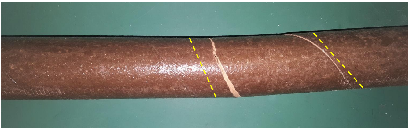
Figura 70. Especimen de prueba ET1-CR-04. Se observa la susceptibilidad de falla por ruptura por el devanado multicapa helicoidal, disminuido por la aplicación de la resina epóxica como recubrimiento.
