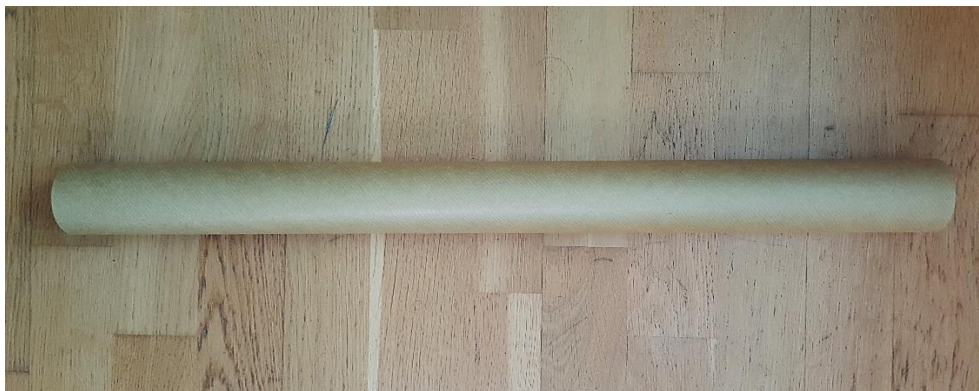
Figura X3. Tubos de sección cilíndrica compuestos por cartón Kraft, utilizados como fase en los especímenes de prueba.
