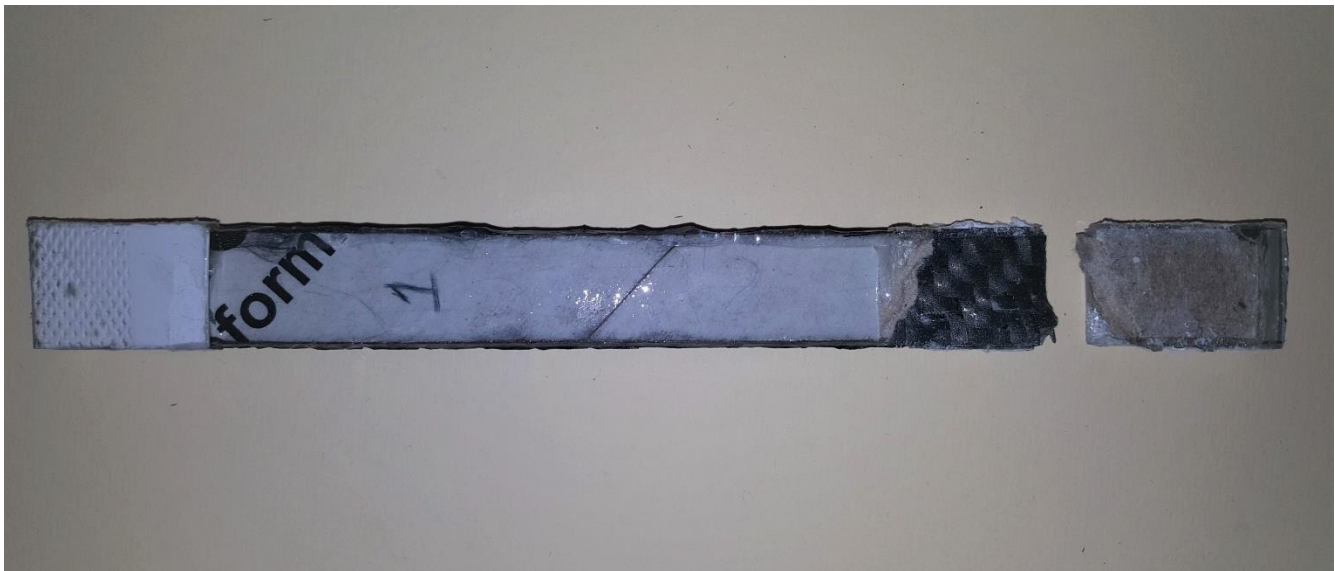
Figura 83. Espécimen de prueba ET2-CF-01. En la imagen se percibe la desunión de los materiales componentes, significando la falta de adherencia en la zona de interface.
