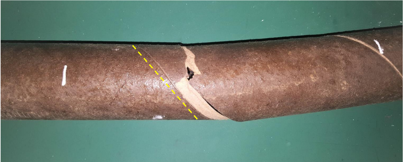
Figura 71. Especimen de prueba ET1-CR-03. Fenómeno de desprendimiento entre capas de las capas exteriores con resina epóxica de la fase matriz de cartón.
