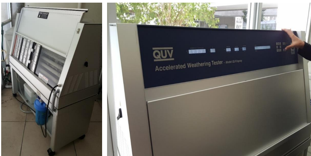
Figura 97 - 98. Colocación de soportes en cámara de intemperismo y programación de ciclo 6 (normas ASTM G-154).
