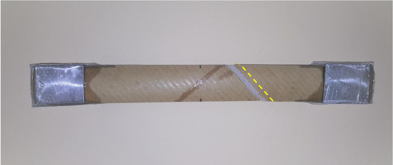
Figura 65. Espécimen de prueba ET2-CA-02. Se observa que en los especímenes del muestreo ET2-CA-n las fallas por rotura se presentaron en una posición media entre el centro y los extremos de sujeción.
