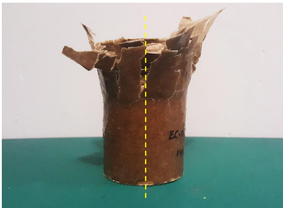
Figura 45. Espécimen de prueba EC1-CR-08. Efecto de delaminación de las capas externas recubiertas por resina epóxica.
