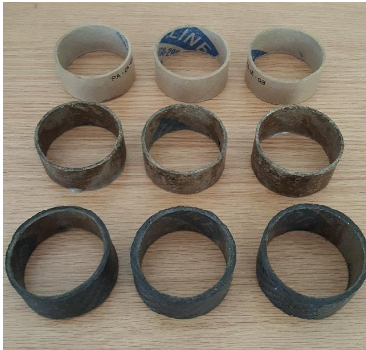
Figura 106. Especímenes para ensayo de absorción de humedad, tres variables (H-CA-n, H-CR-n, H-CF-n).
