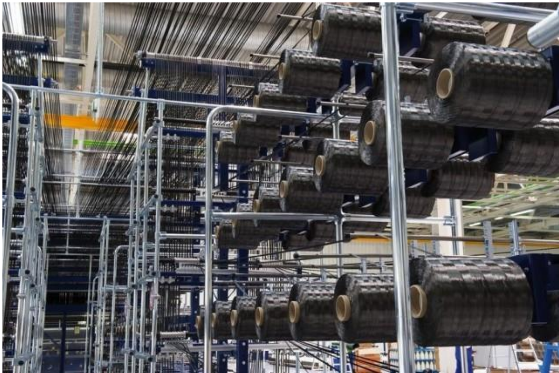
Figura 20. Producción de fibra de carbón, en planta de BMW, (proceso de enrollamiento de fibras).
