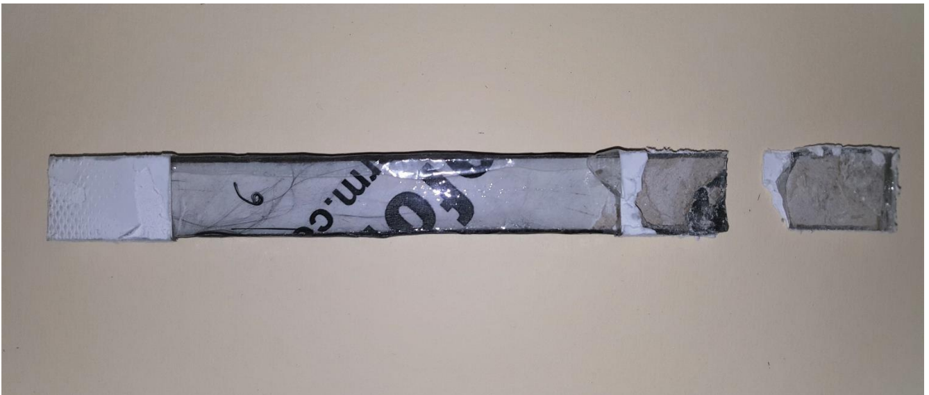
Figura 81. Espécimen de prueba ET2-CF-06. Las fallas por rotura de los especímenes tipo ET2-CF-n se presentaron dentro de los extremos de sujeción de las mordazas, por la delaminación entre capas de la fase matriz de cartón.
