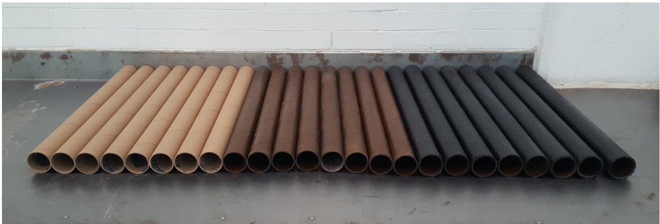
Figura 86. Comparación de especímenes de prueba ET1 de las tres variables experimentadas, previo al ensayo a esfuerzos de tensión.
