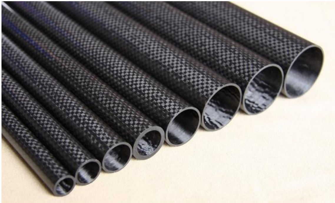
Figura 19. Tubos comerciales de fibras de carbono. Las fibras son entretrejidas en mallas para luego formar los tubos.
