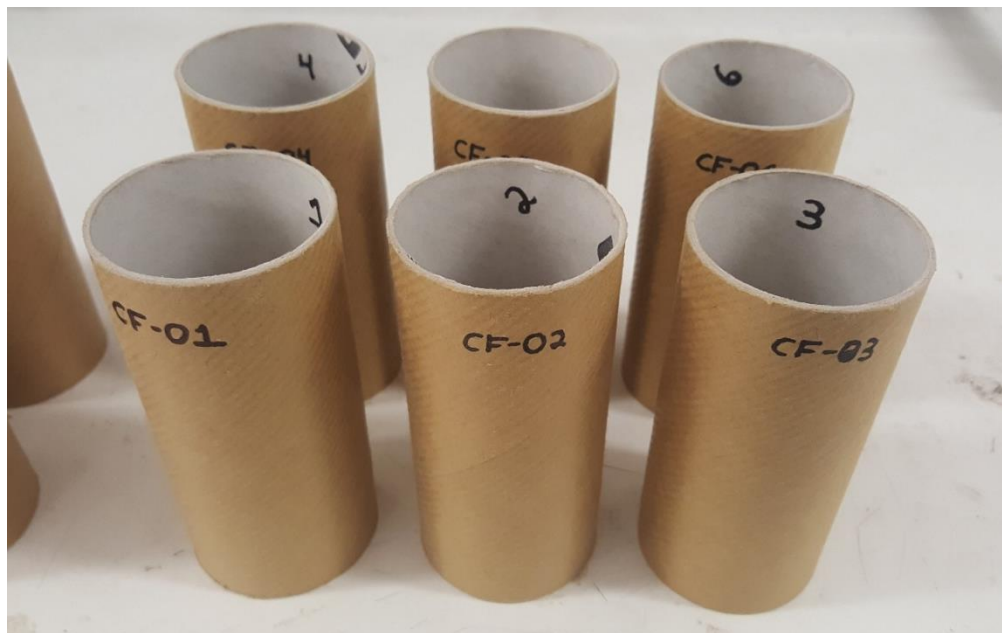
Figura 34. Especímenes de prueba EC2-CA-n para ensayo a la compresión.
