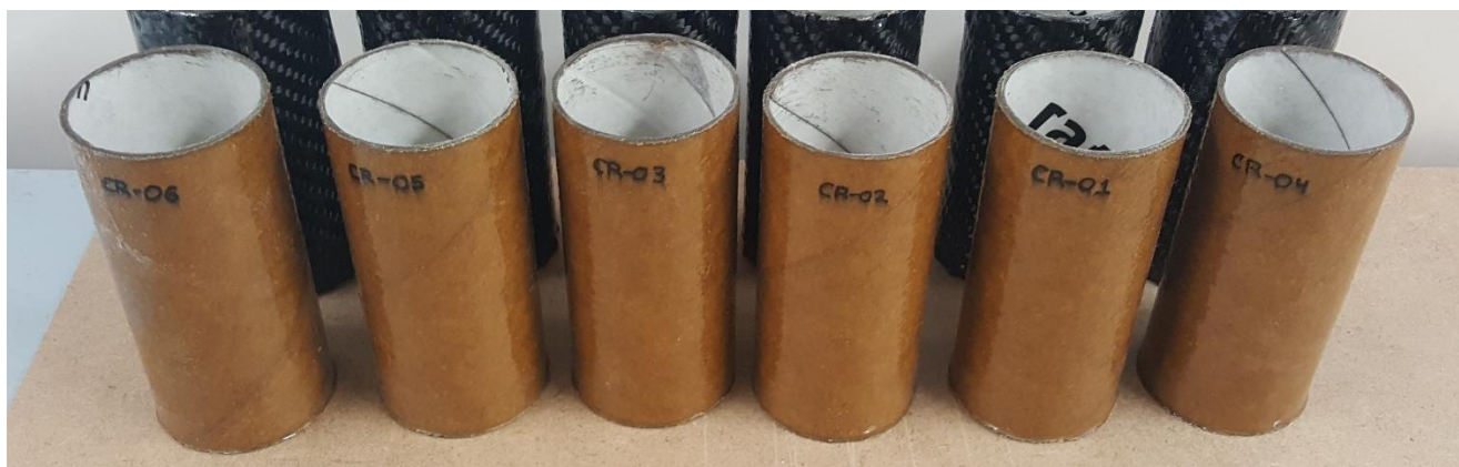
Figura X35. Especímenes de prueba EC2-CR-n para ensayo a la compresión.
