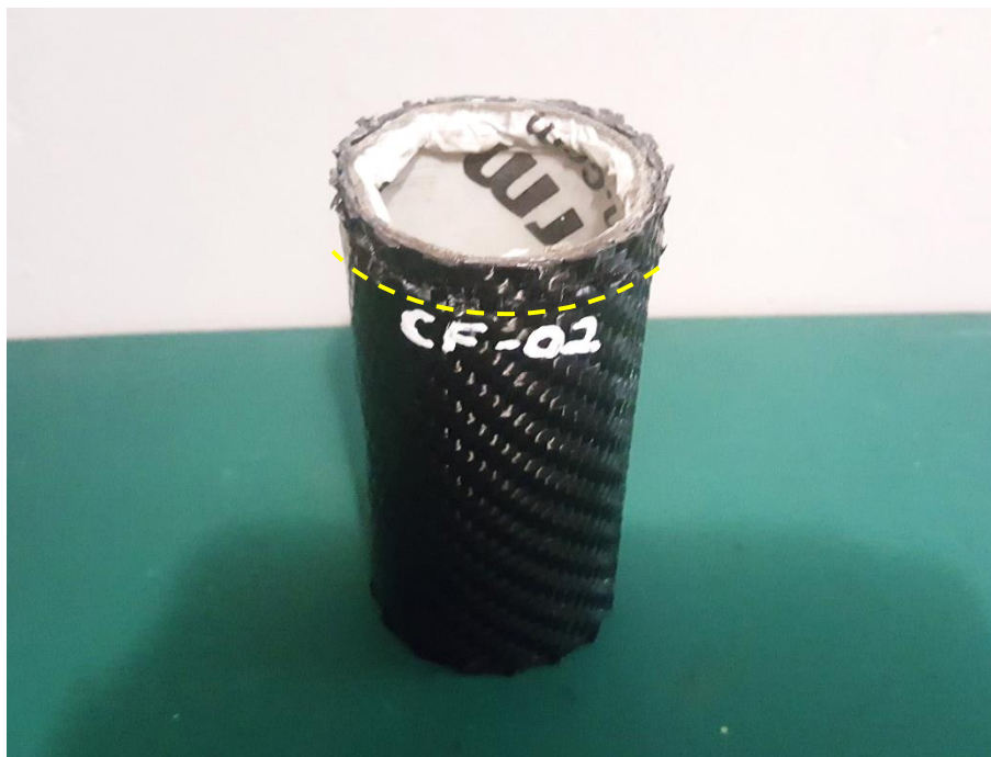
Figura 51. Espécimen de prueba EC2-CF-02. Debido a la elevada rigidez del material compuesto, el elemento presenta escasa deformación. Al interior del tubo se observa la deformación de la fase matriz de cartón que sirve como base para el tejido de fibras de carbono.
