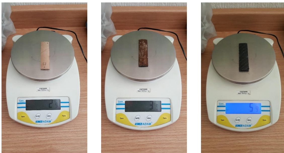
Figuras 92 - 94. Pesaje de especímenes de prueba en instrumento de medición (I-CA-n, I-CR-n, I-CF-n).
