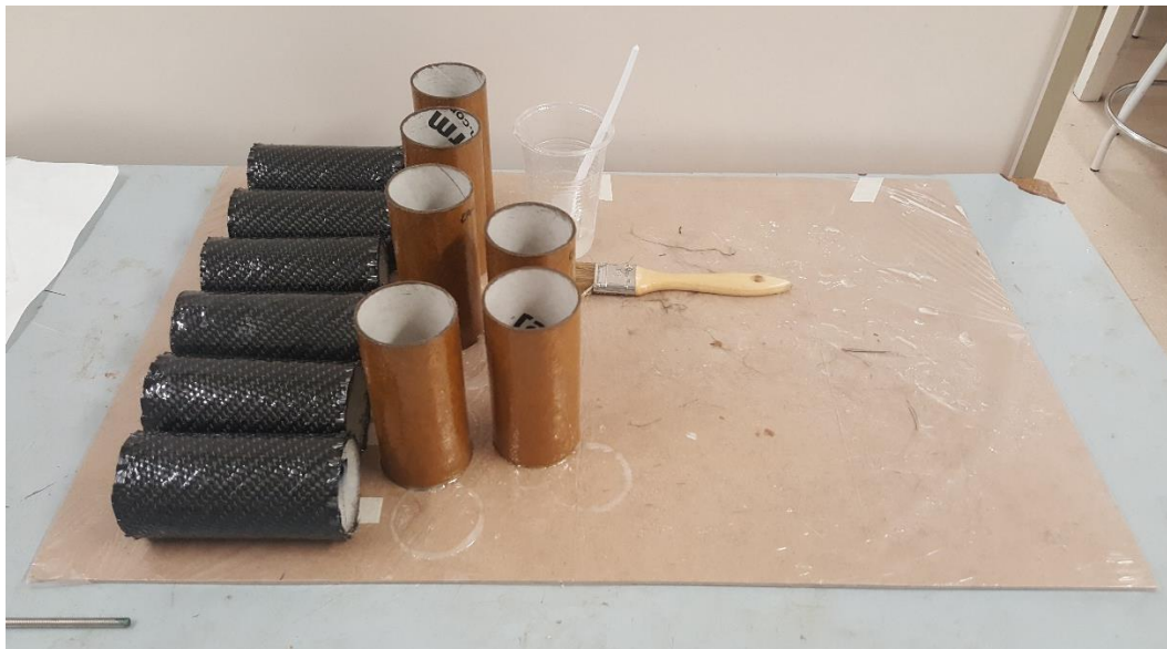
Figura X15. Proceso de secado a temperatura ambiente de especímenes de prueba tipo EC2-CR-n y EC2-CF-n para ensayo de esfuerzos a compresión.
