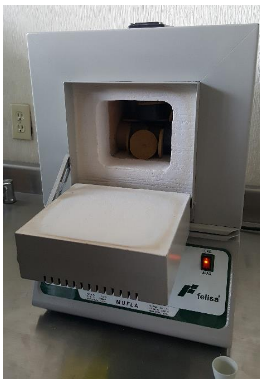
Figura 107. Especímenes de ensayo introducidos en la mufla para iniciar proceso de secado (H-CA-n, H-CR-n, H-CF-n).
