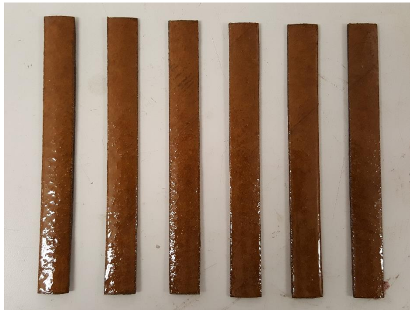
Figura X11. Proceso de secado a temperatura ambiente de especímenes de prueba tipo ET2-CR-n para ensayo de esfuerzos a tensión.
