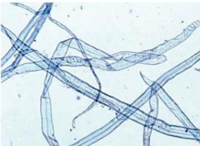
Figura 8. Fibras de madera de pino. Se caracterizan por ser largas y planas (Igggesund Paperboard, 2017).
