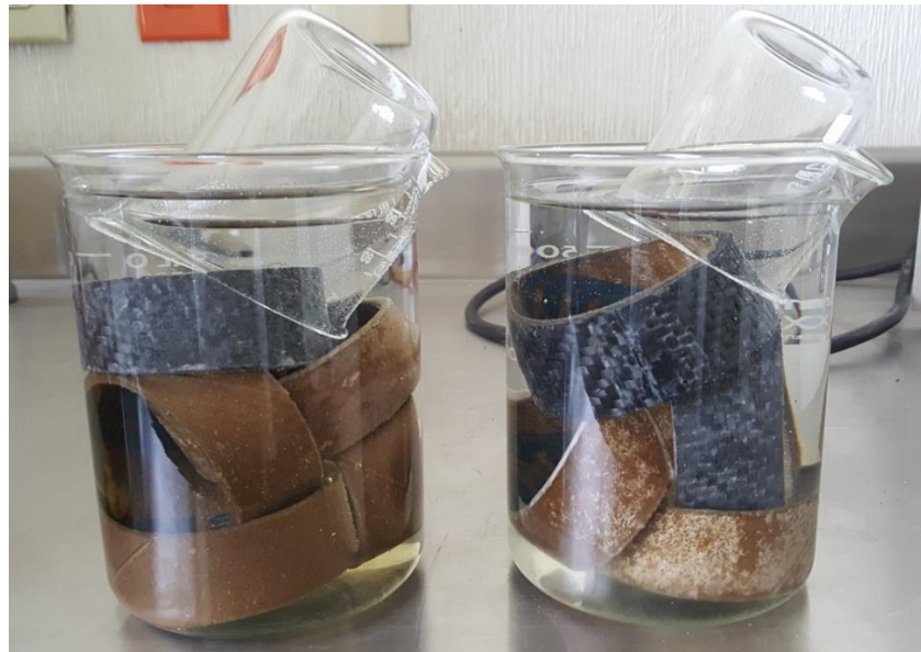
Figura 111. Proceso de inmersión en agua destilada de los especímenes de prueba, tres variables (H-CA-n, H-CR-n, H-CF-n).
