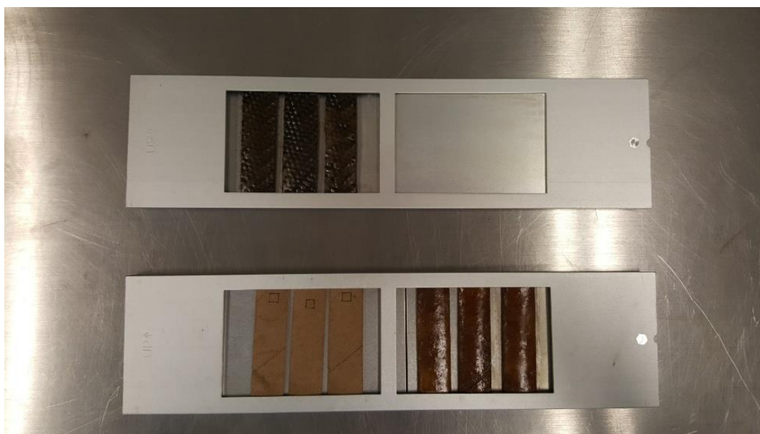
Figura 99. Especímenes de prueba en soportes posteriores a ensayo en cámara de intemperismo.
