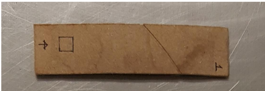
Figura 104. Especímen de prueba I-CA-01 posterior a ensayo, en el que se observa la flexión del elemento al centro.
