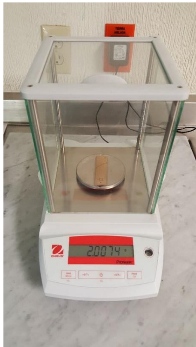
Figuras 101 - 103. Pesaje de especímenes de prueba en instrumento de medición, posterior a ensayo (I-CA-n, I-CR-n, I-CF-n).
