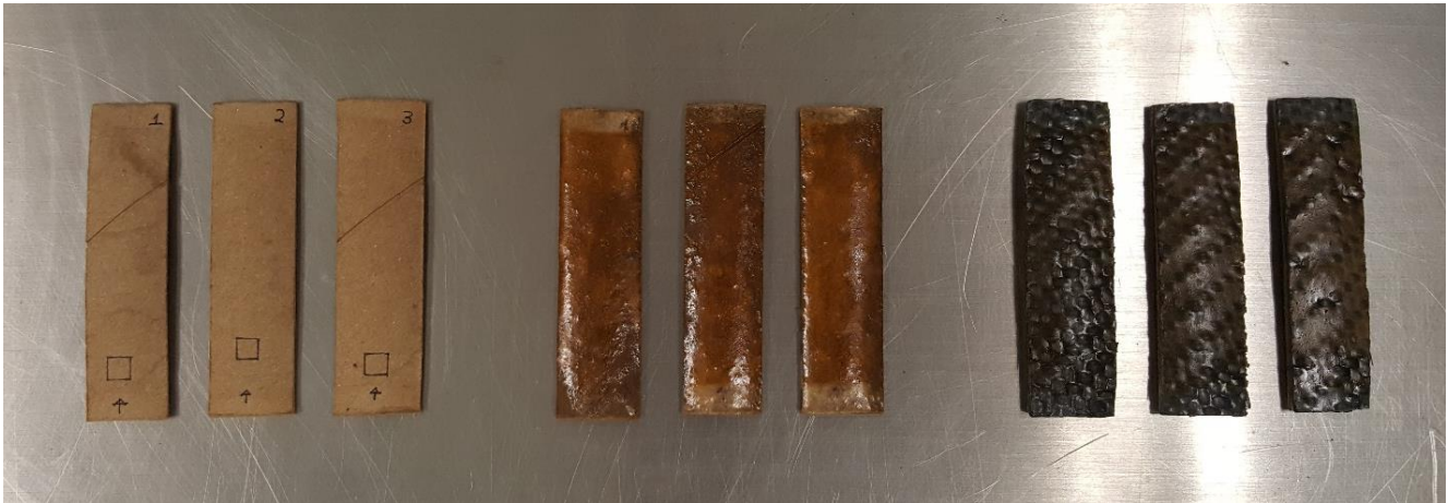
Figura 100. Especímenes de prueba posteriores a ensayo en cámara de intemperismo. Se observa el cambio de coloración por el ensayo en las esquinas de las especímenes de prueba.
