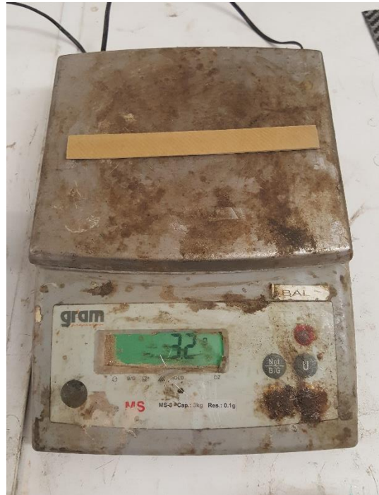
Figura X7. Pesaje de muestra ET2-CA para ensayo de esfuerzos a tensión con báscula digital en área de laboratorio LITEM, UPC.
