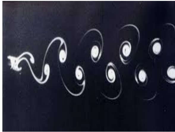
Figura 3.15: Desprendimiento de vórtices causado por la interacción de un flujo con una obstrucción. Este fenómeno se conoce como calle de vórtices de Von Karman. (Van Dyke, 1982) [Internet]
