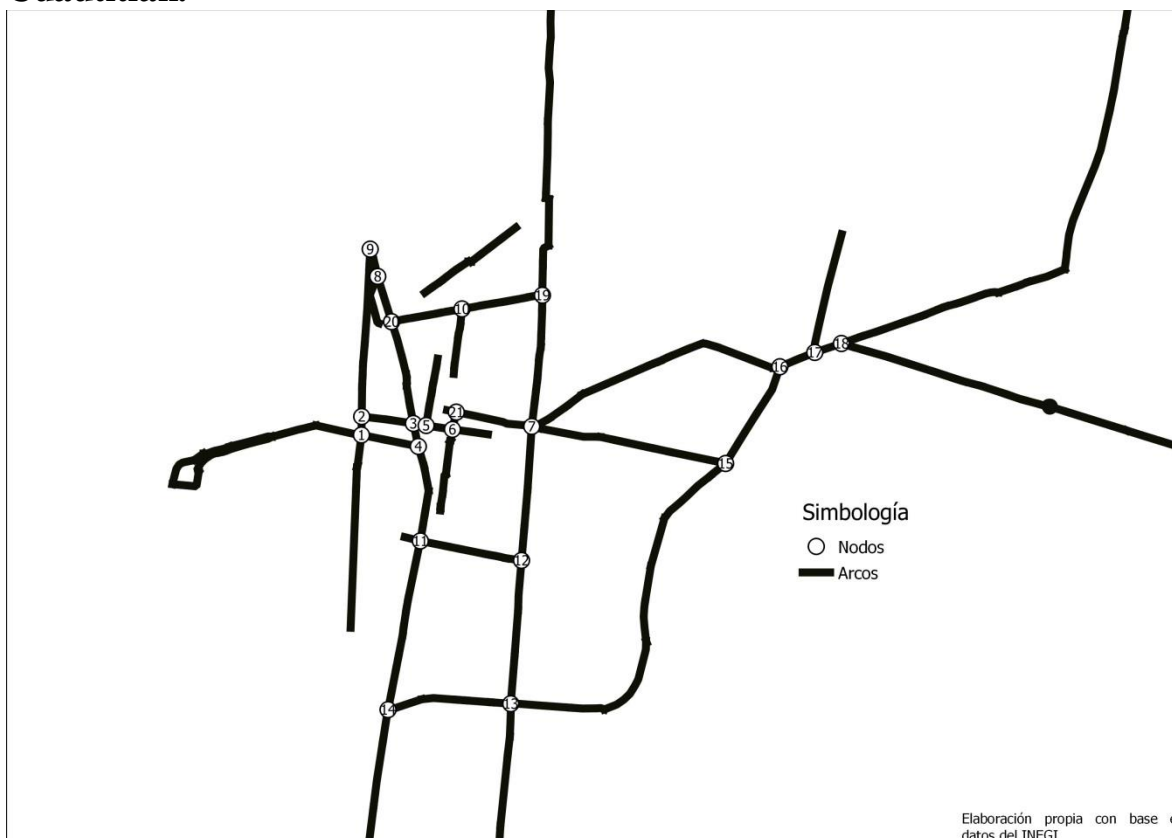
Figura 3.2 Representación del grafo de la red vial del municipio de Cuautitlán.
